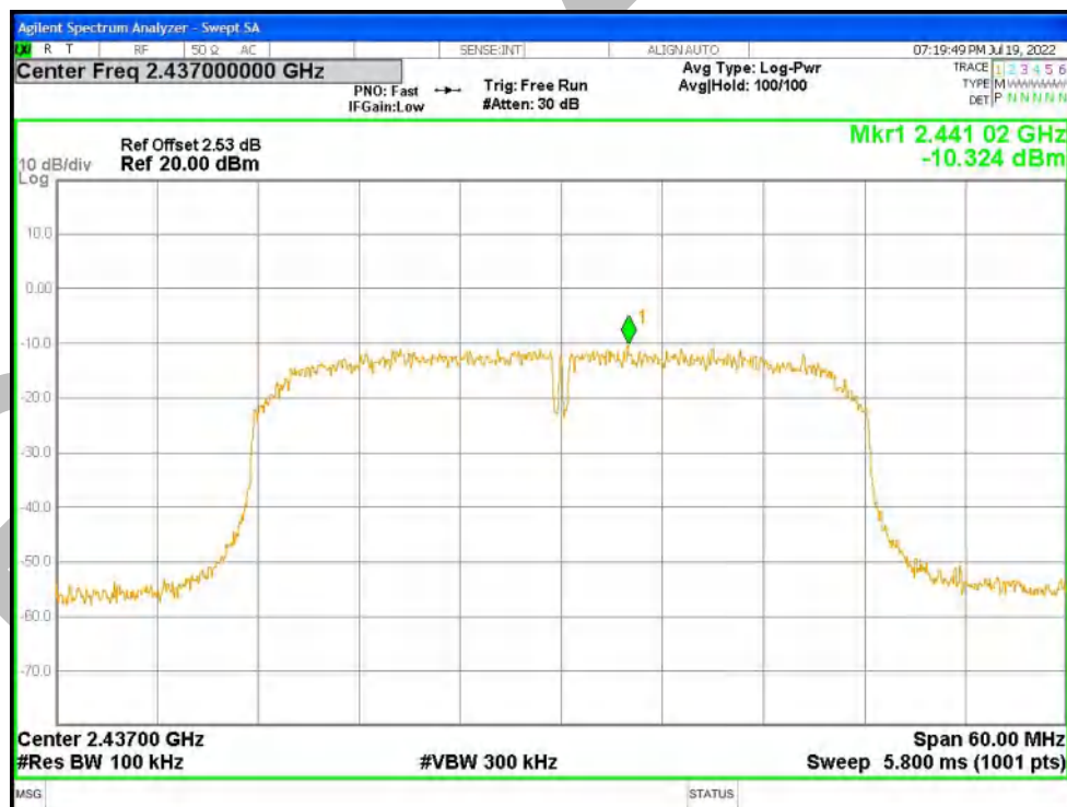
PSD NVNT n40 2452MHz Ant1
