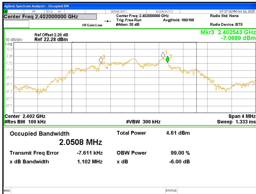
-6dB Bandwidth NVNT BLE 2M 2442MHz Ant1
