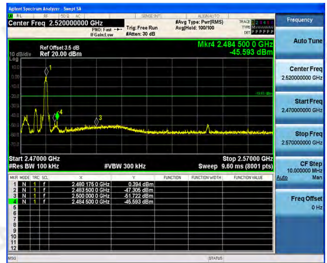
Right Band edge hopping off
