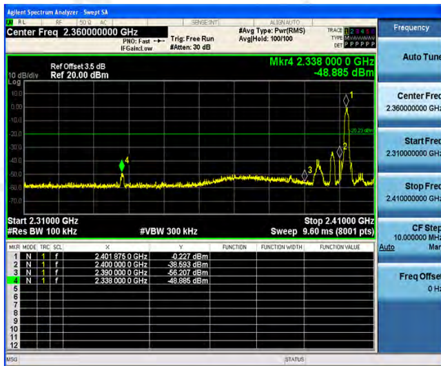
Left Band edge hopping off
