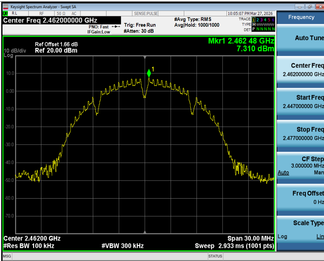
Band Edge NVNT b 2462MHz Ant1 Ref
