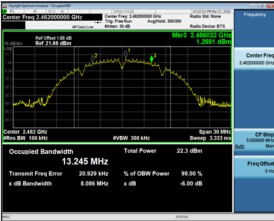
-6dB Bandwidth NVNT b 2462MHz Ant1
