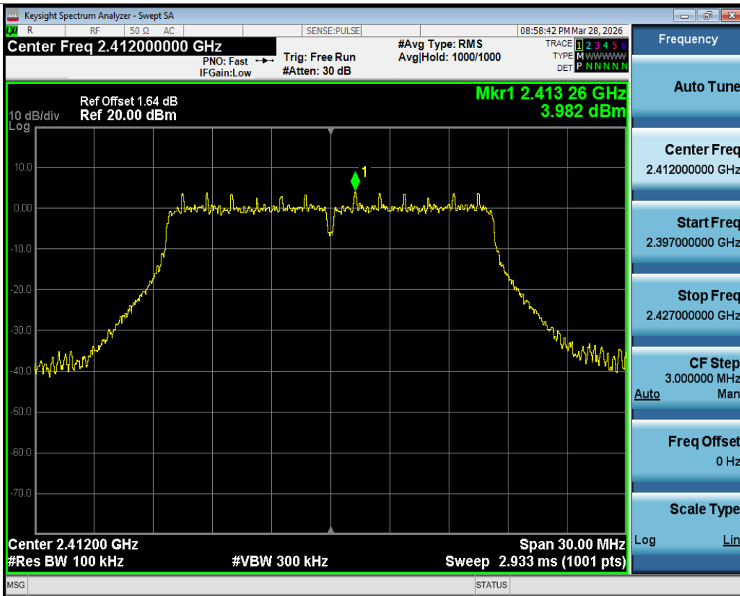
Band Edge NVNT g 2412MHz Ant1 Ref
