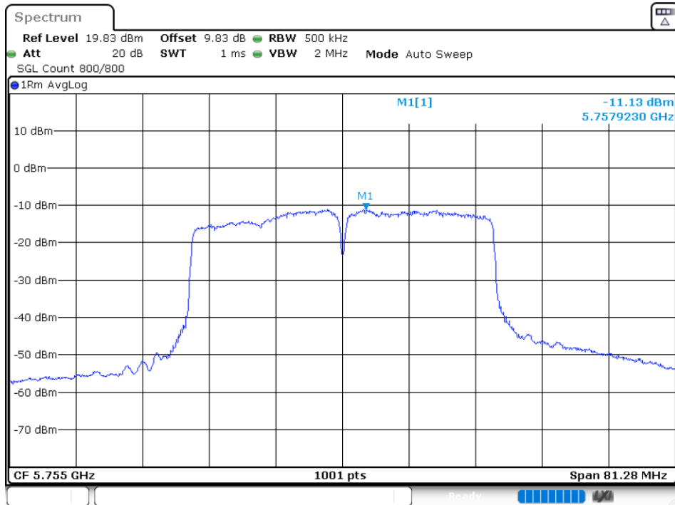
PSD NVNT 802.11n(HT40) 5755MHz Ant1
