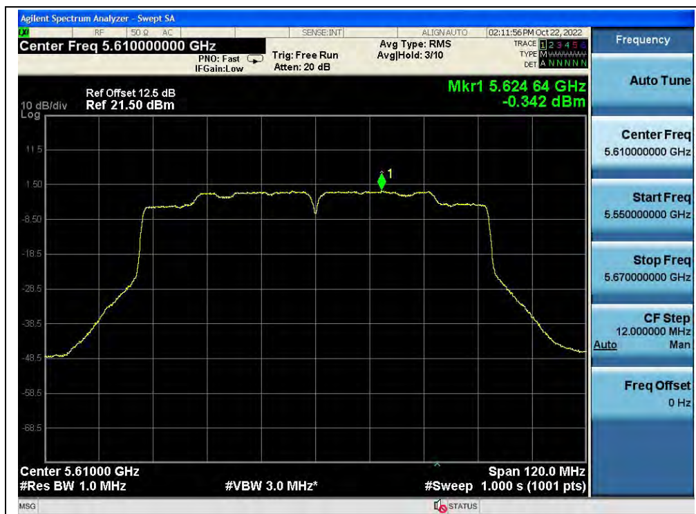
(Channel 122, 5610MHz, 802.11ac (VHT80), ANT0)
