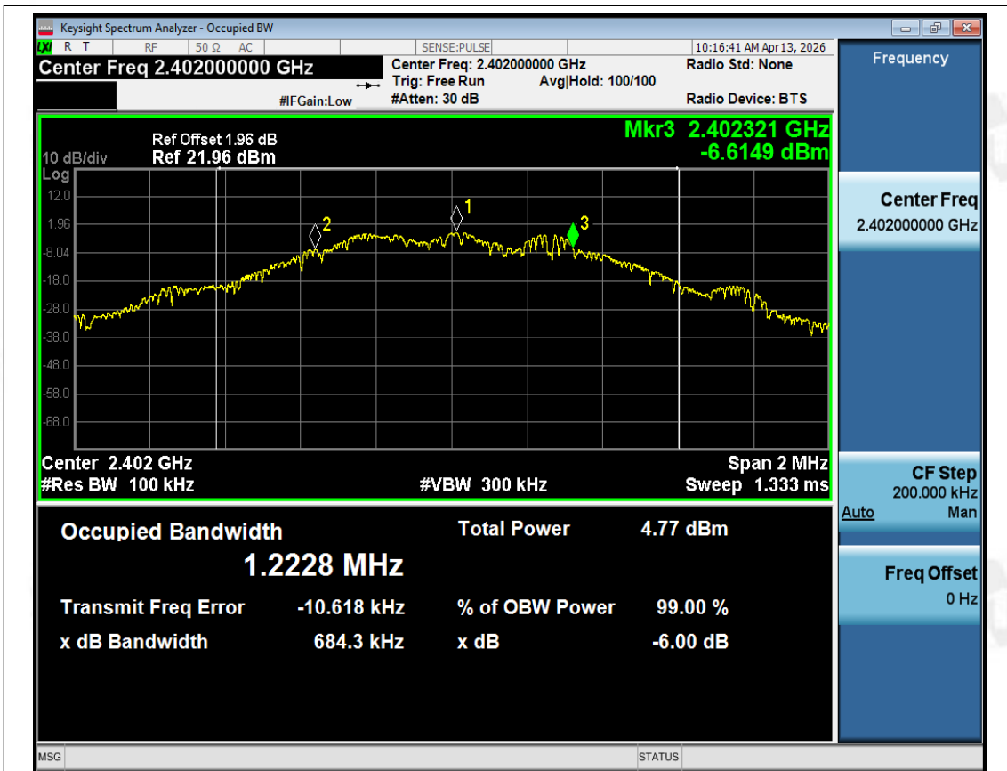
-6dB Bandwidth NVNT BLE 1M 2402MHz Ant1
