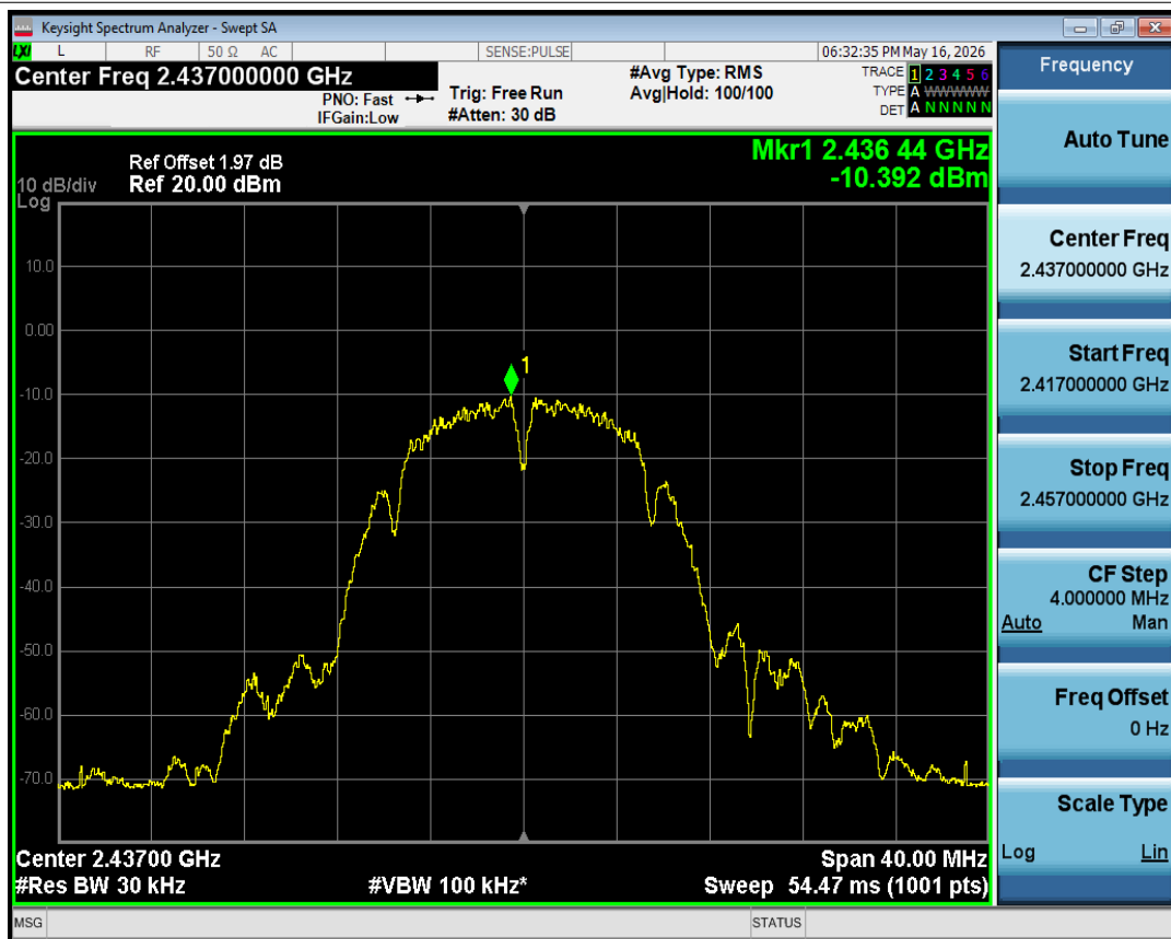
PSD NVNT b 2437MHz Ant1
