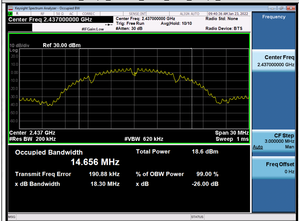
Test_Graph_802.11b_ANT1_2437_1Mbps_OBW
