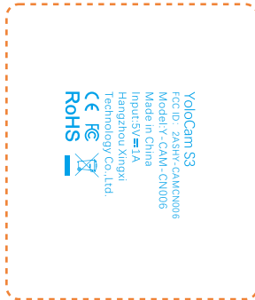
产品主体后视图，丝印 (深灰色) PANTONE423C, 等线字体。
