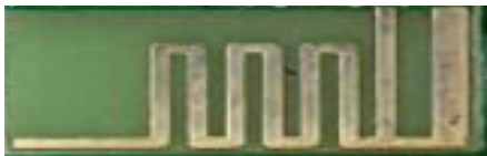
Antenna Dimension: 10 x 0.7 mm
