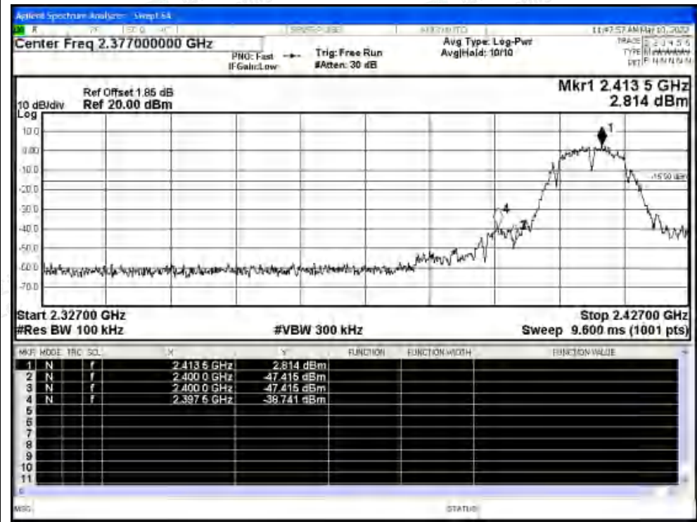
Band Edge NVNT b 2412MHz Ant0 Emission
