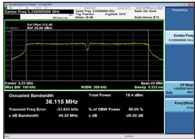
U-NII-1 26dB Bandwidth-802.11ac(80MHz) ,5210MHz,Ant1
