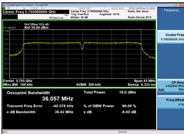
U-NII-3 6dB Bandwidth-802.11ac(40MHz) ,5795MHz,Ant0
