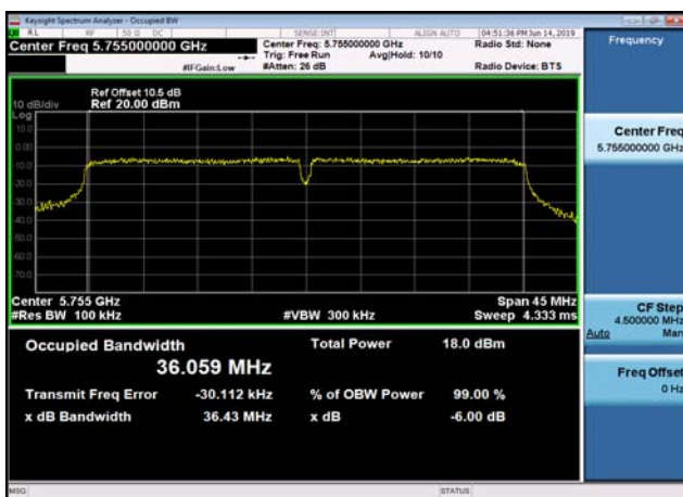
U-NII-3 6dB Bandwidth-802.11n(40MHz) ,5755MHz,Ant0
