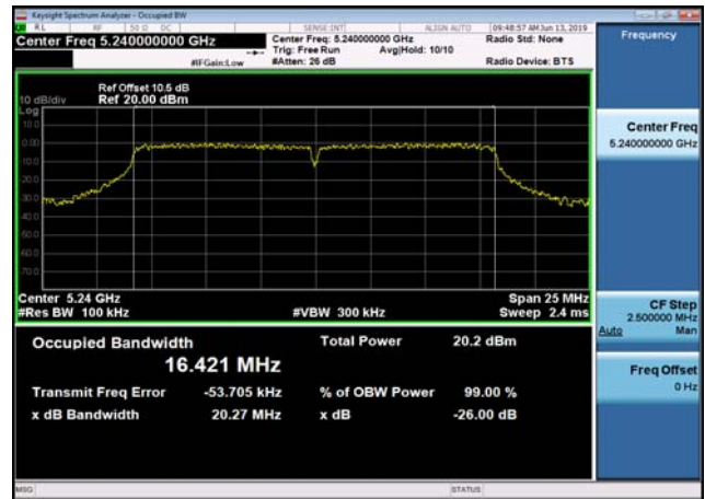
U-NII-1 26dB Bandwidth-802.11ac(20MHz) ,5180MHz,Ant1
