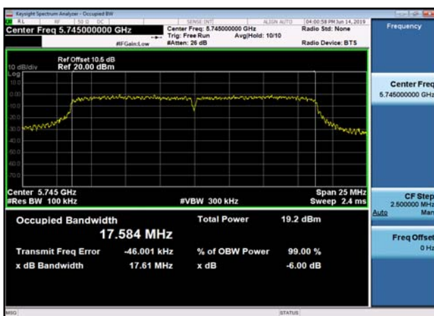
U-NII-3 6dB Bandwidth-802.11n(20MHz) ,5745MHz,Ant0
