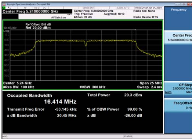
U-NII-1 26dB Bandwidth-802.11ac(20MHz) ,5180MHz,Ant0
