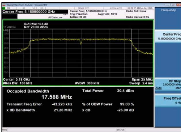
U-NII-1 26dB Bandwidth-802.11ac(20MHz) ,5180MHz,Ant0
