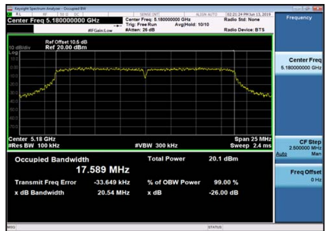
U-NII-1 26dB Bandwidth-802.11ac(20MHz) ,5180MHz,Ant1
