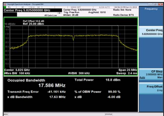
U-NII-3 6dB Bandwidth-802.11n(40MHz) ,5755MHz,Ant1
