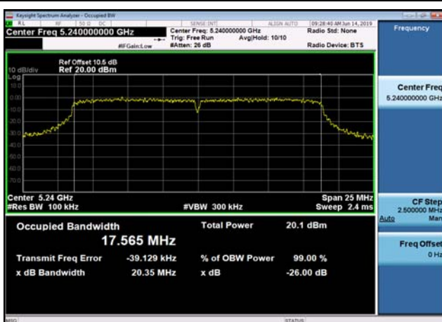
U-NII-1 26dB Bandwidth-802.11n(20MHz) ,5240MHz,Ant0
