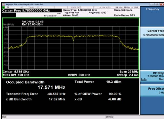
U-NII-3 6dB Bandwidth-802.11ac(20MHz) ,5785MHz,Ant0
