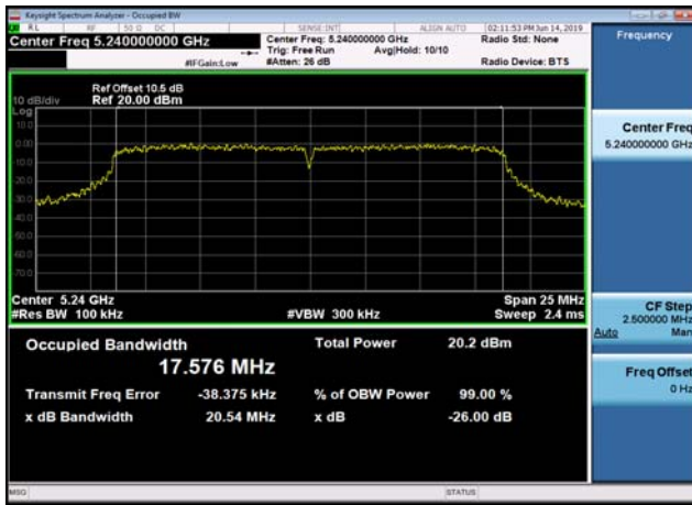
U-NII-1 26dB Bandwidth-802.11ac(40MHz ,5190MHz,Ant0
