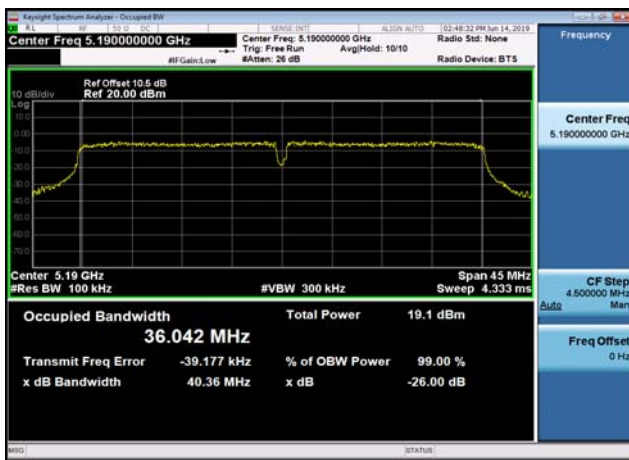
U-NII-1 26dB Bandwidth-802.11ac(40MHz ,5190MHz,Ant0
