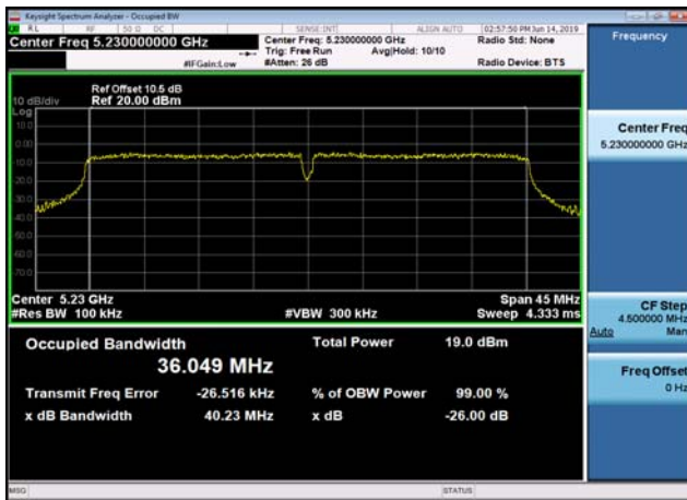
U-NII-1 26dB Bandwidth-802.11ac(80MHz) ,5210MHz,Ant0
