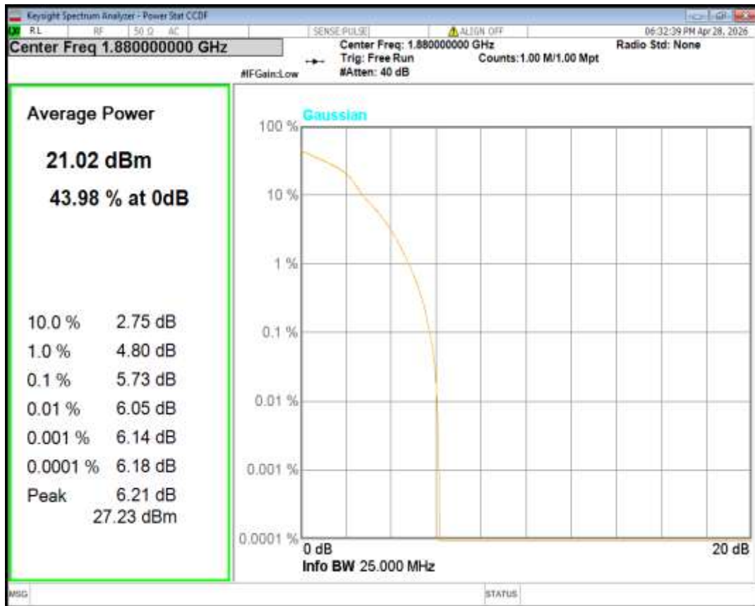
Band2 QPSK BW=10MHz Channel=18650 RB Size=1 Position=#0
