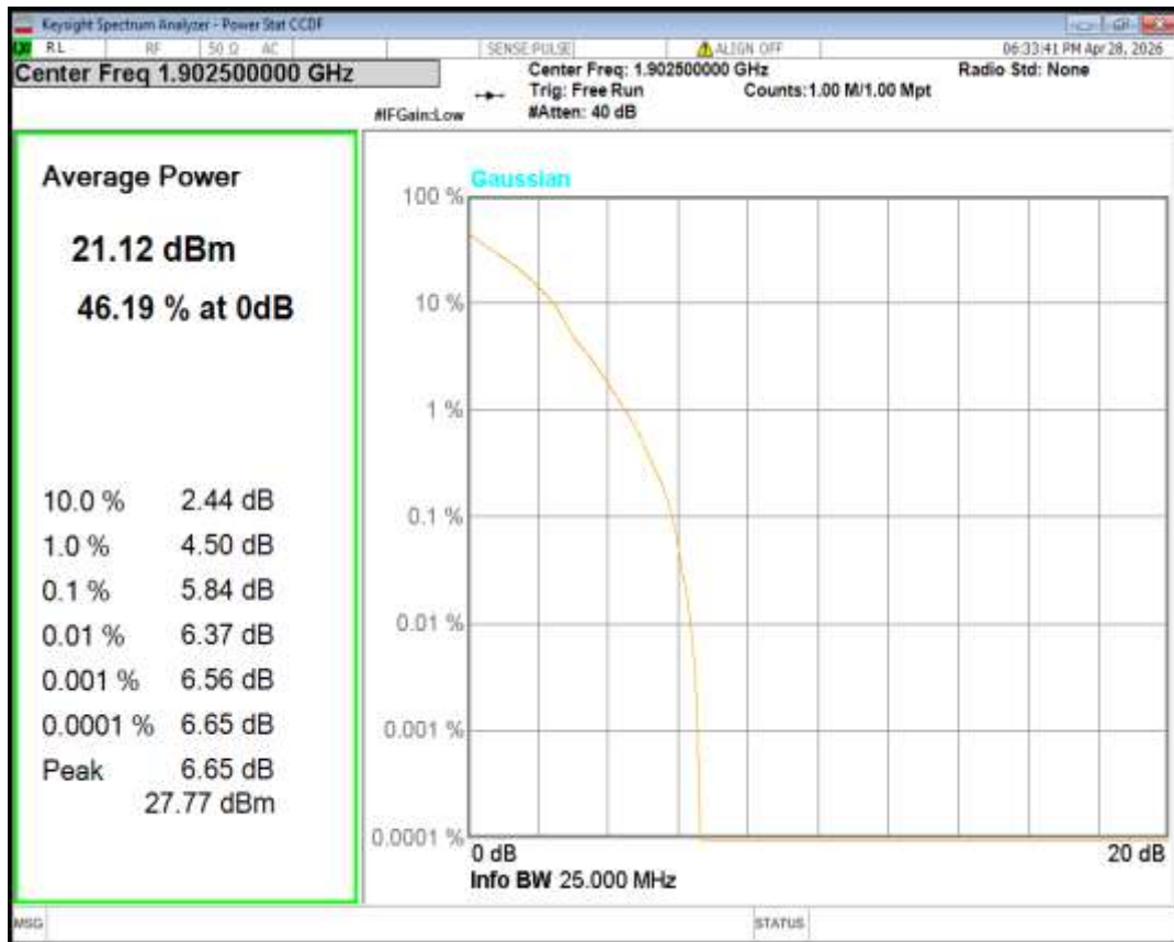
Band2 QPSK BW=20MHz Channel=18700 RB Size=1 Position=#0
