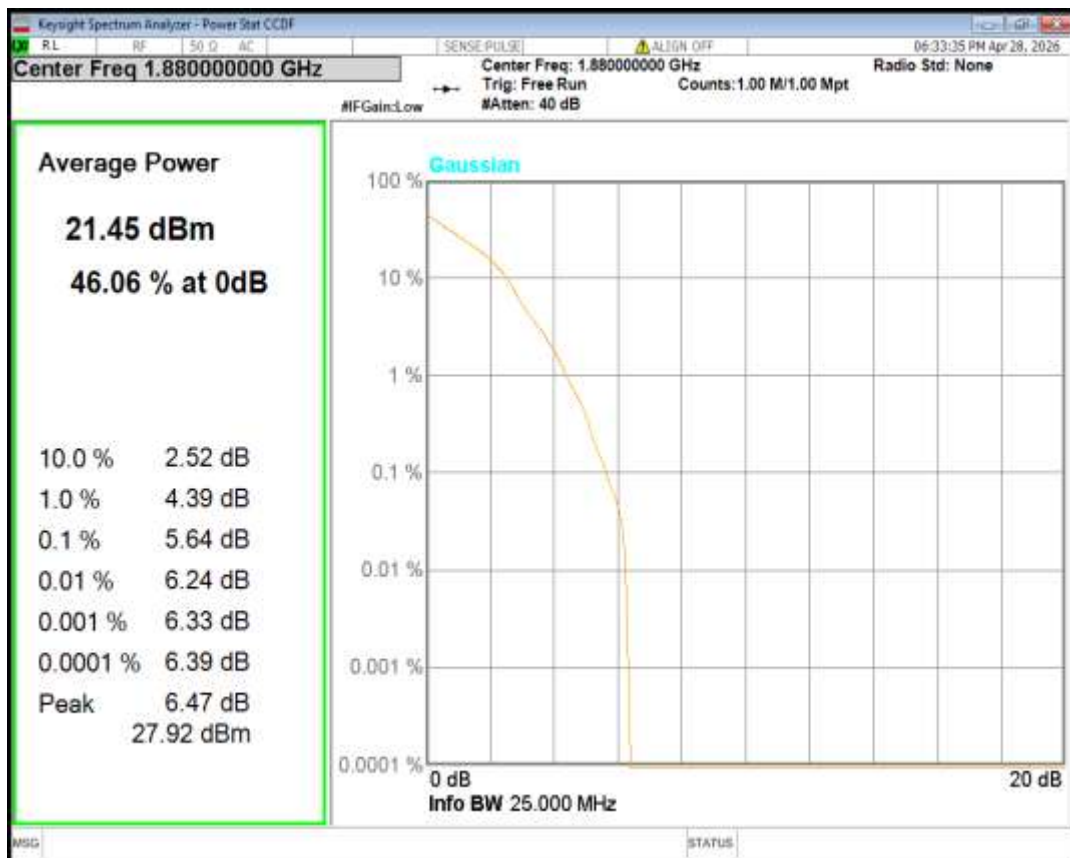
Band2 QPSK BW=15MHz Channel=19125 RB Size=1 Position=#0
