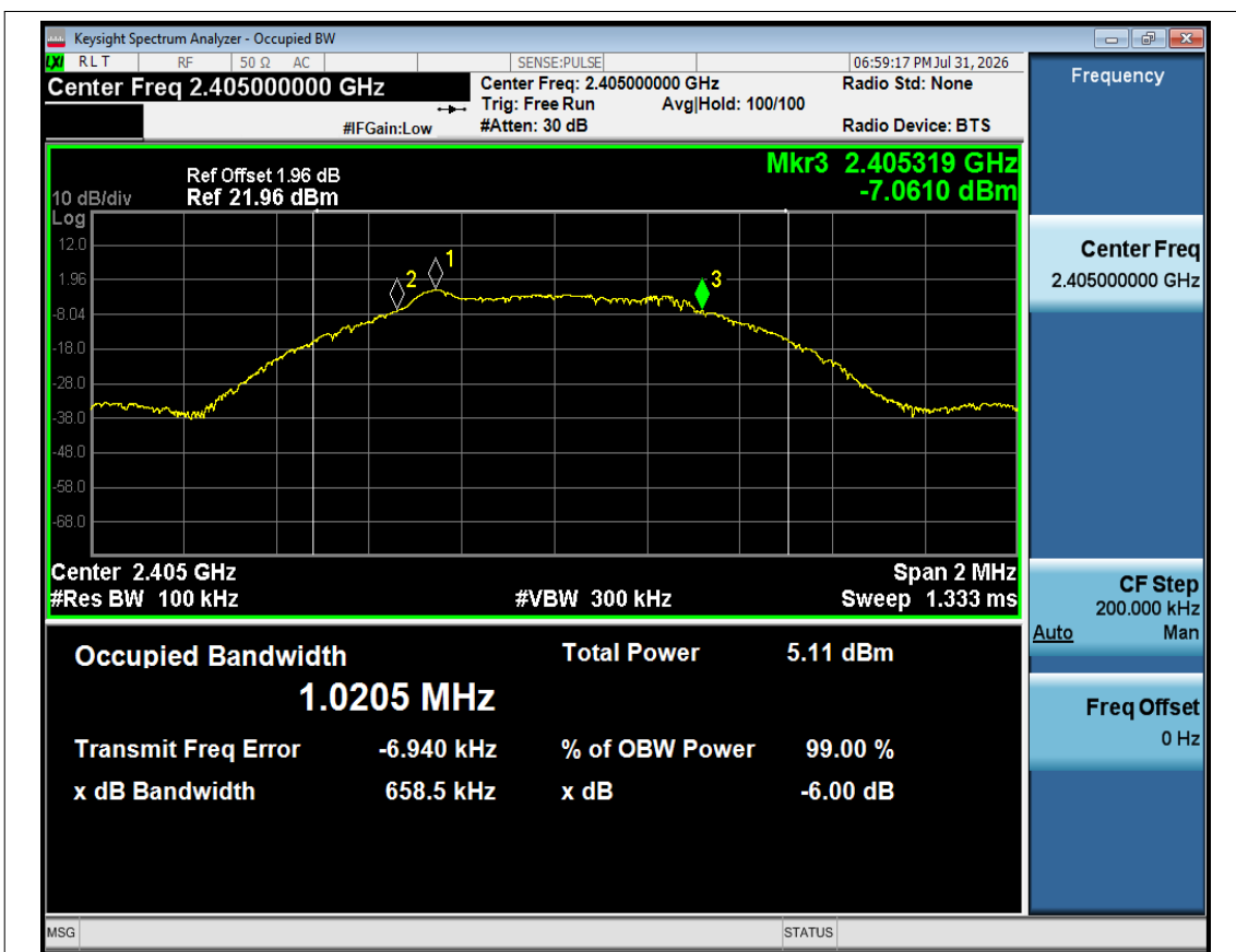
-6dB Bandwidth NVNT GFSK 2405MHz Ant1
