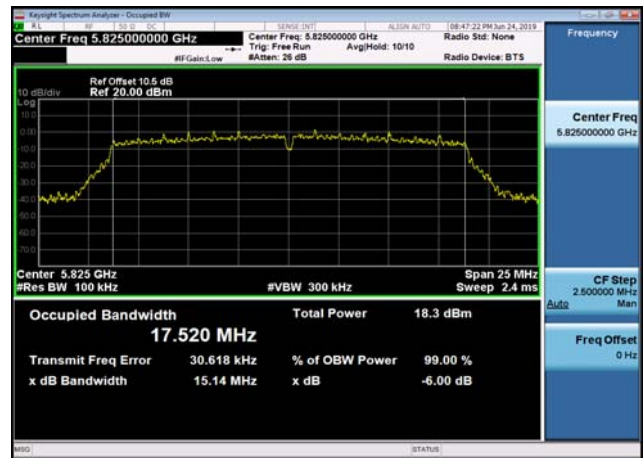
U-NII-3 6dB Bandwidth-802.11ac(40MHz) ,5755MHz,Ant2
