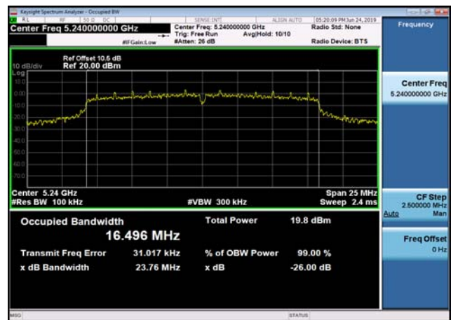
U-NII-1 26dB Bandwidth-802.11ac(20MHz) ,5180MHz,Ant2
