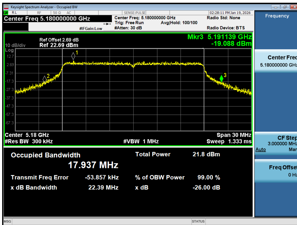
-26dB Bandwidth NVNT ac20 5180MHz Ant1
