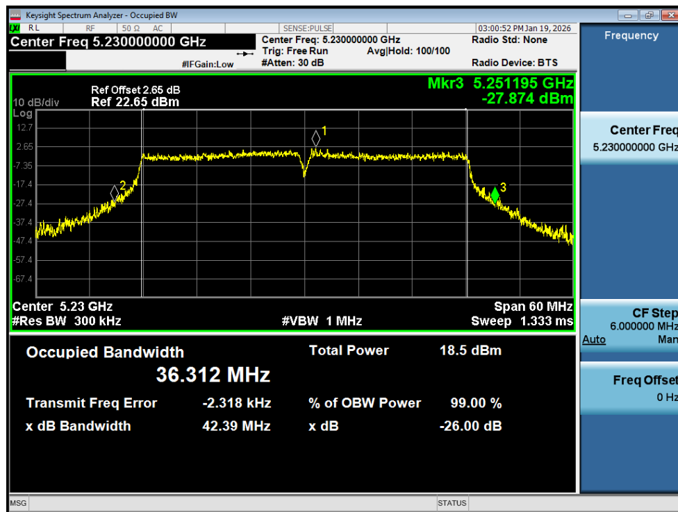
-26dB Bandwidth NVNT n40 5230MHz Ant2
