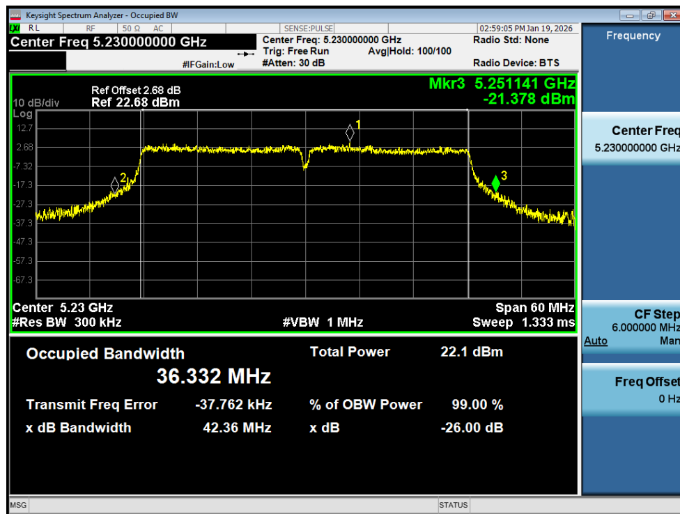
-26dB Bandwidth NVNT n40 5230MHz Ant1
