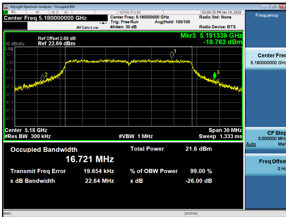
-26dB Bandwidth NVNT a 5180MHz Ant1
