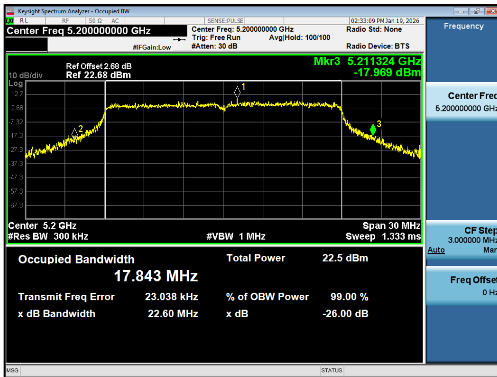
-26dB Bandwidth NVNT ac20 5200MHz Ant1
