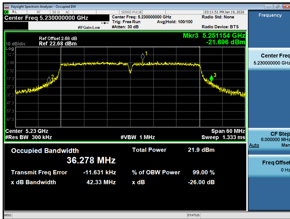
-26dB Bandwidth NVNT ac40 5230MHz Ant1
