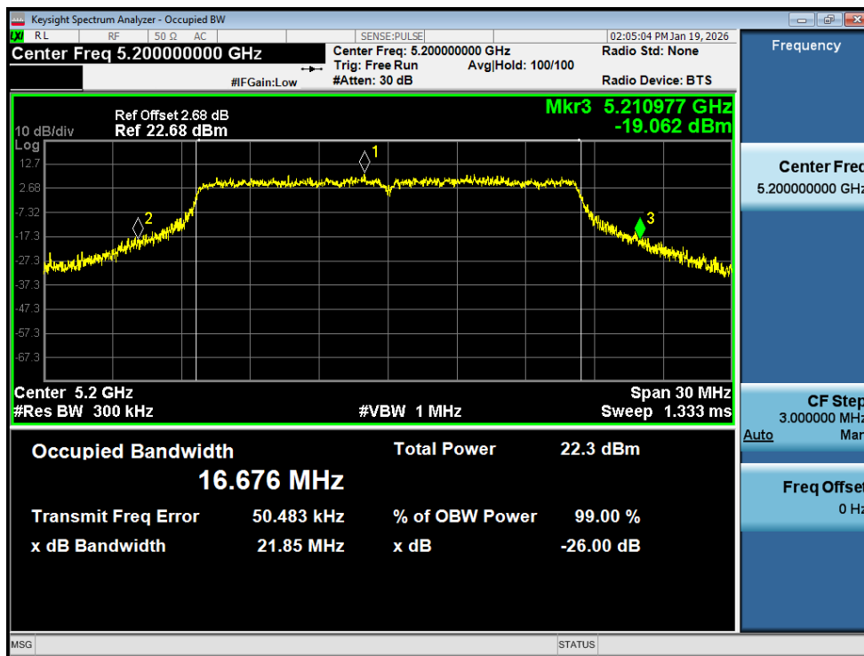
-26dB Bandwidth NVNT a 5200MHz Ant1
