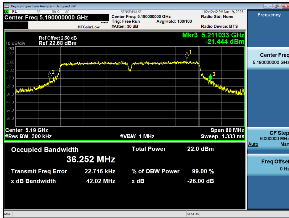
-26dB Bandwidth NVNT n40 5190MHz Ant1
