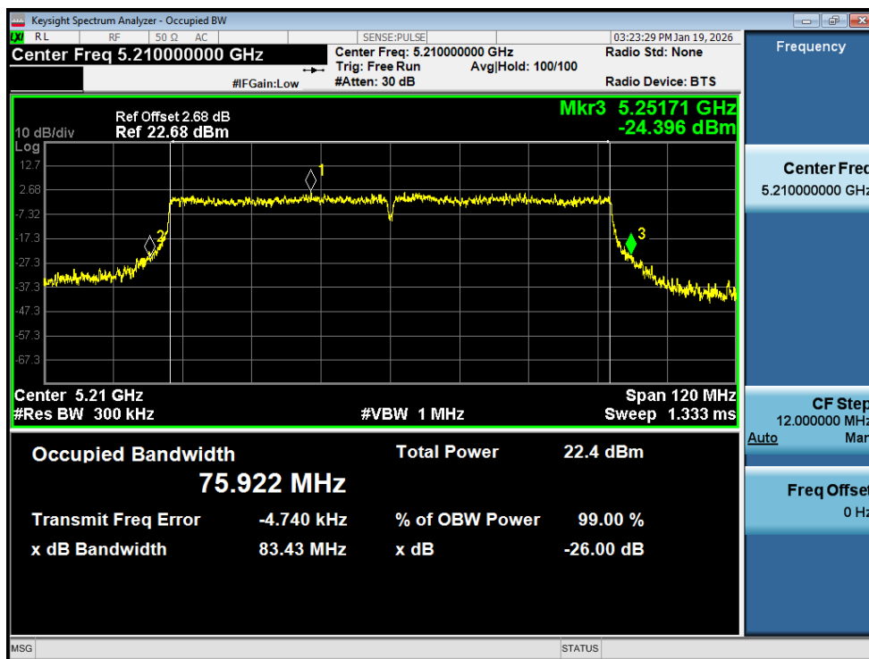
-26dB Bandwidth NVNT ac80 5210MHz Ant1
