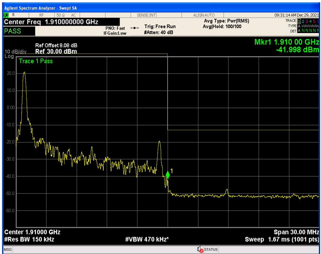
Band2 QPSK BW=20MHz Channel=18700 RB Size=1 Position=#0
