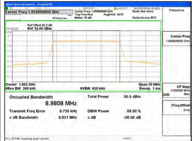
Band2 / 10MHz / QPSK/ Low CH
