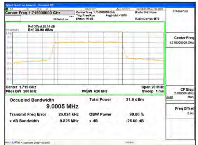
Band4 / 10MHz / QPSK/ Low CH
