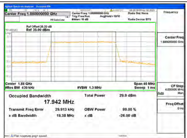
Band2 / 20MHz / 16QAM/ Mid CH
