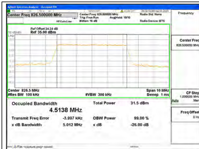
Band5 / 5MHz / QPSK/ Low CH
