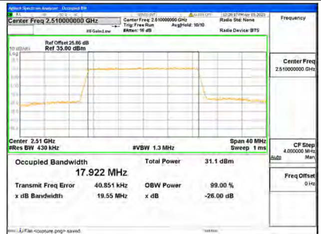
Band7 / 20MHz / QPSK/ Low CH
