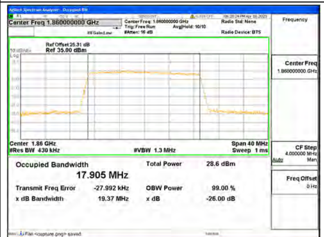
Band2 / 20MHz / 64QAM/ Low CH
