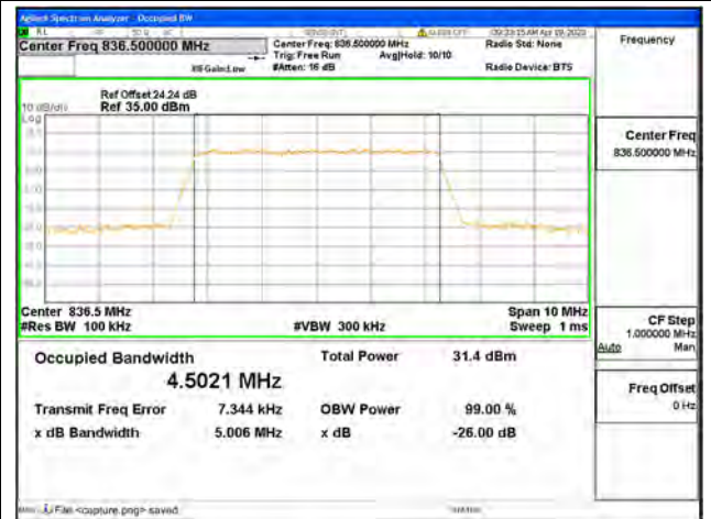
Band5 / 5MHz / QPSK/ Mid CH
