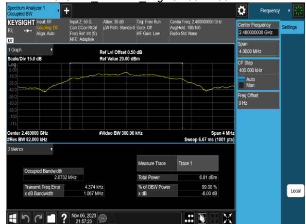
IC OBW BLE 2M HighCH39-2480MHz
