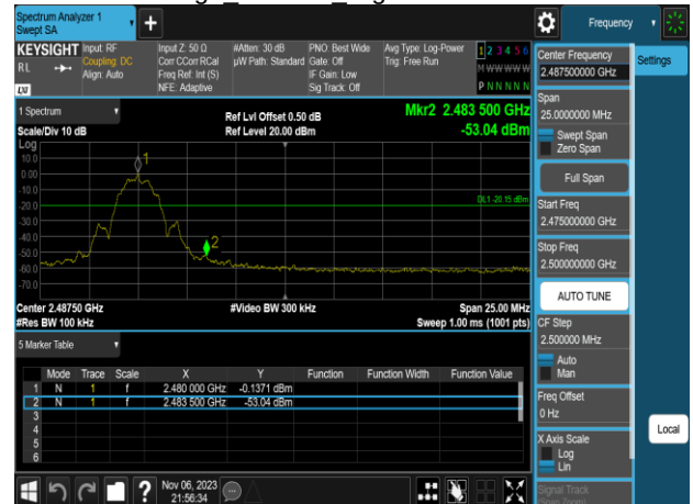
Band Edge BLE 2M HighCH39-2480MHz
