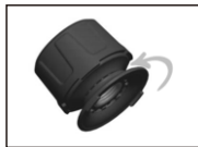
C、若扳手丢失或损坏, 可将防拆底盖取下并方向扣紧传感器, 逆时针旋转拆开传感器
