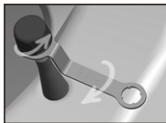
A、用扳手顺时针方向旋转六角螺母, 将其与传感器分离, 再逆时针方向旋转传感器
