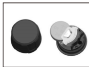
D、取出旧电池并装上新电池 (正极朝上), 最后按照安装步骤重新将传感器安装好
