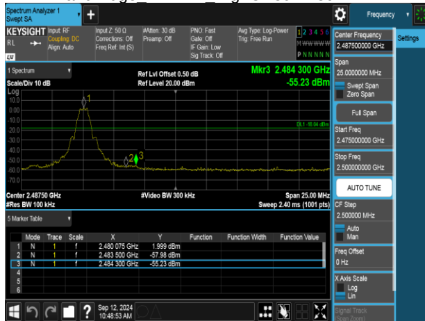
Band Edge BLE 1M HighCH39-2480MHz
