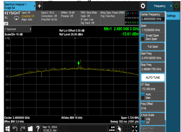
PSD BLE 2M HighCH39-2480MHz
