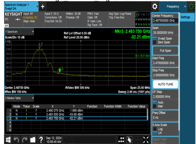
Band Edge BLE 2M HighCH39-2480MHz
