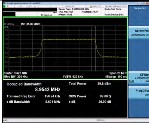
N48-10MHz-256QAM-641666-25RB#0
