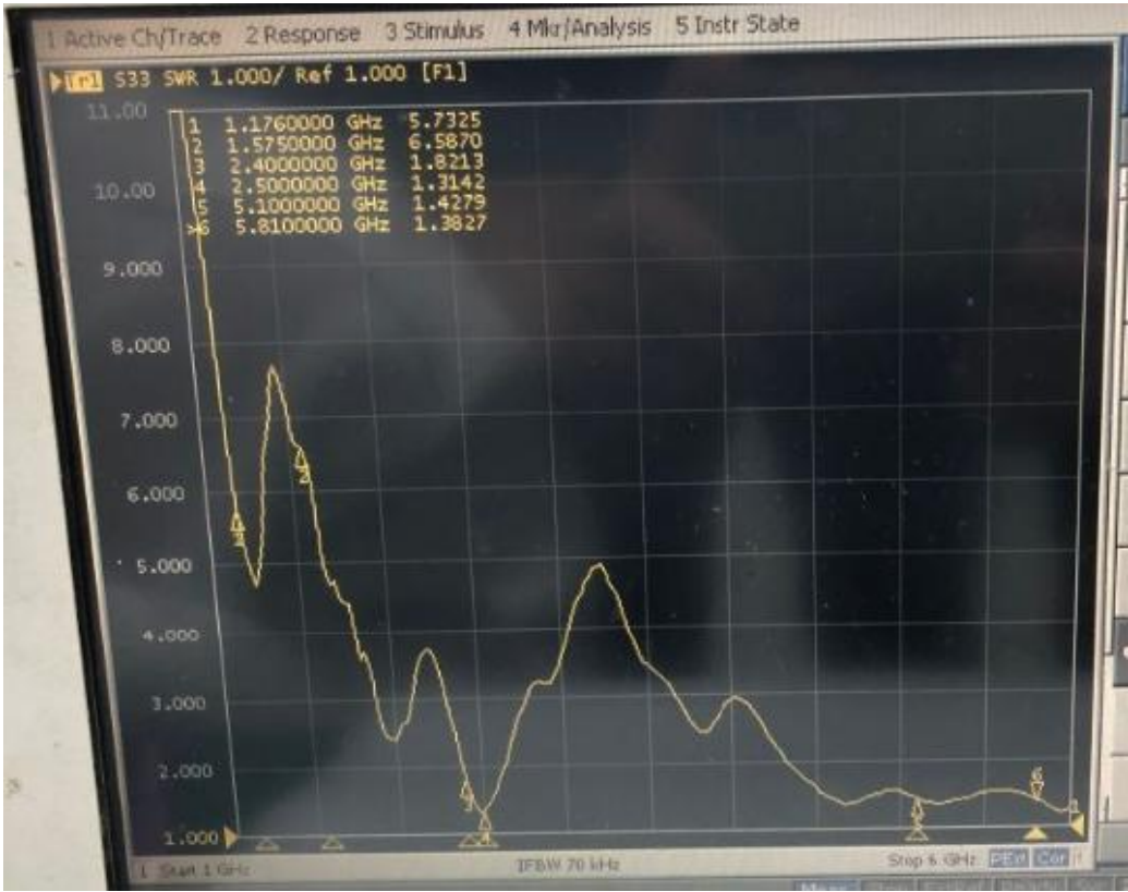
天线驻波比图/Antenna VSWR Plot:
