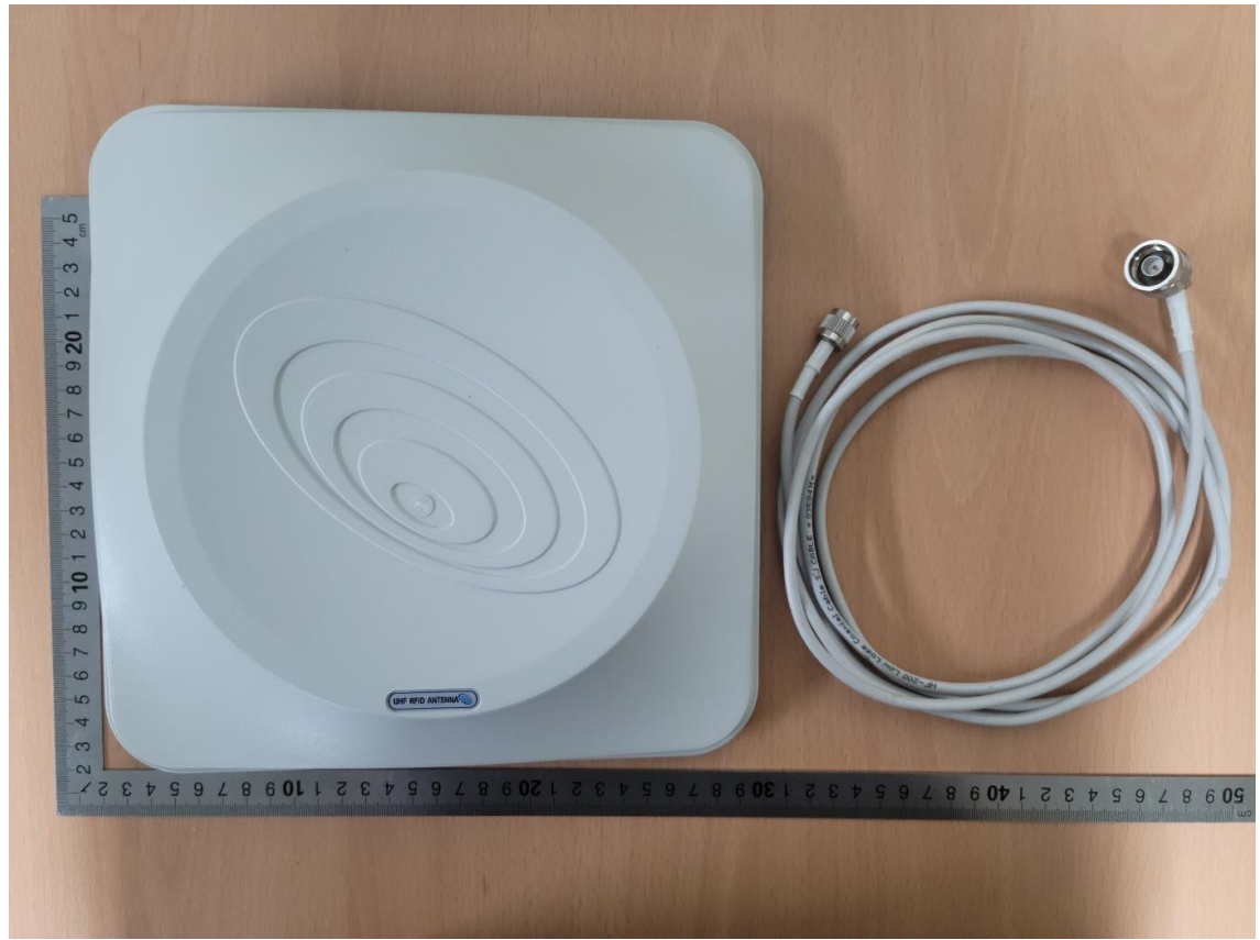
RFID Antenna 1 (M/N: MACRO260-919)
