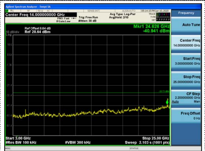
Right Band edge hopping on
