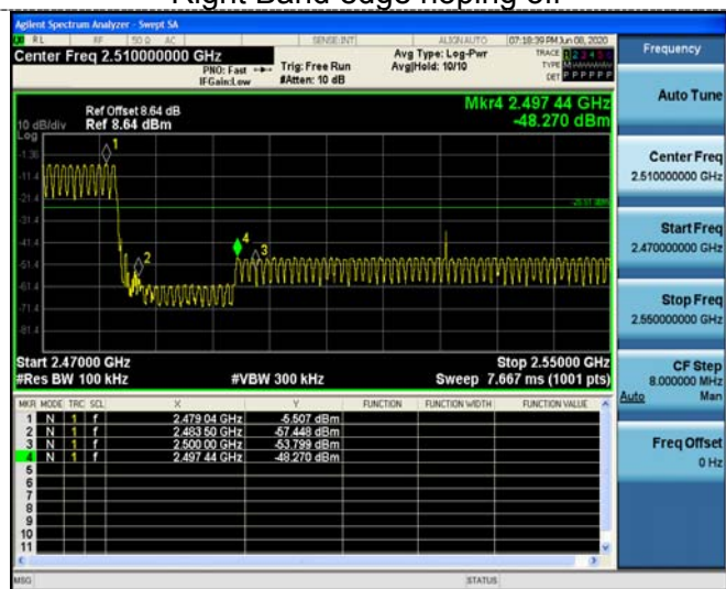
Right Band edge hopping on
