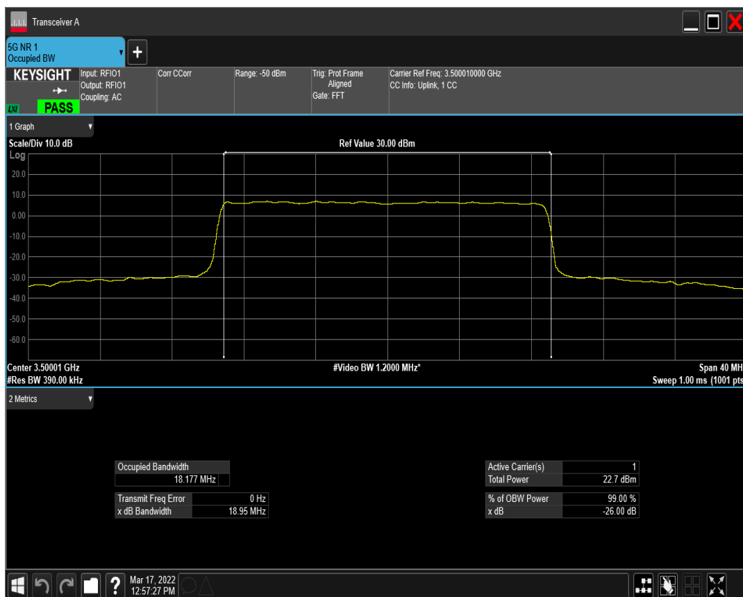
n77(3450-3550) SCS=30kHz DFT_QAM256 BW=20MHz Channel=633334 RB=50@0
