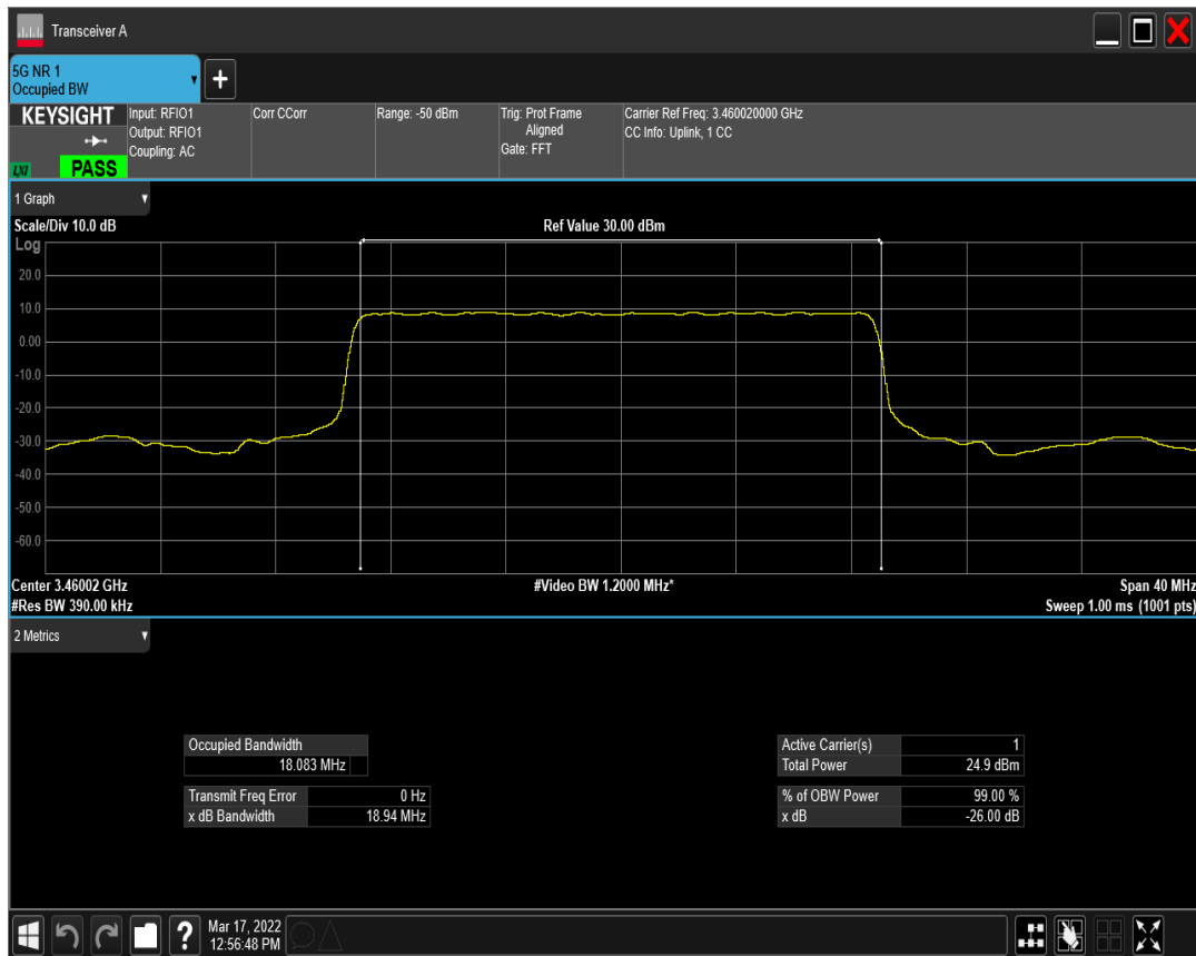
n77(3450-3550) SCS=30kHz DFT_QPSK BW=20MHz Channel=630668 RB=50@0
