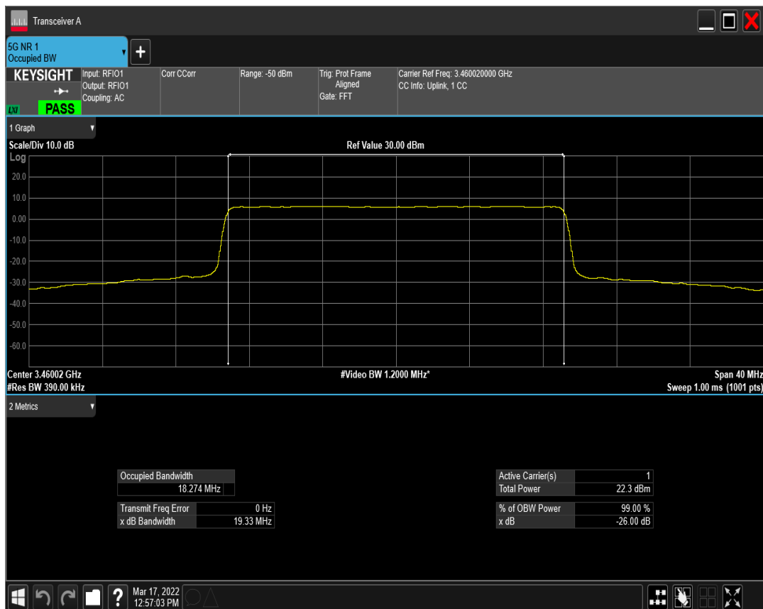
n77(3450-3550) SCS=30kHz DFT_BPSK BW=20MHz Channel=633334 RB=50@0
