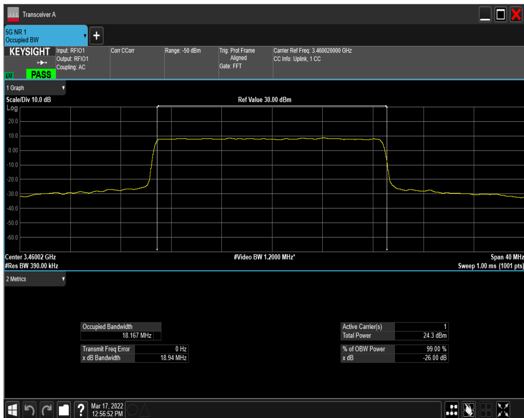
n77(3450-3550) SCS=30kHz DFT_QAM16 BW=20MHz Channel=630668 RB=50@0
