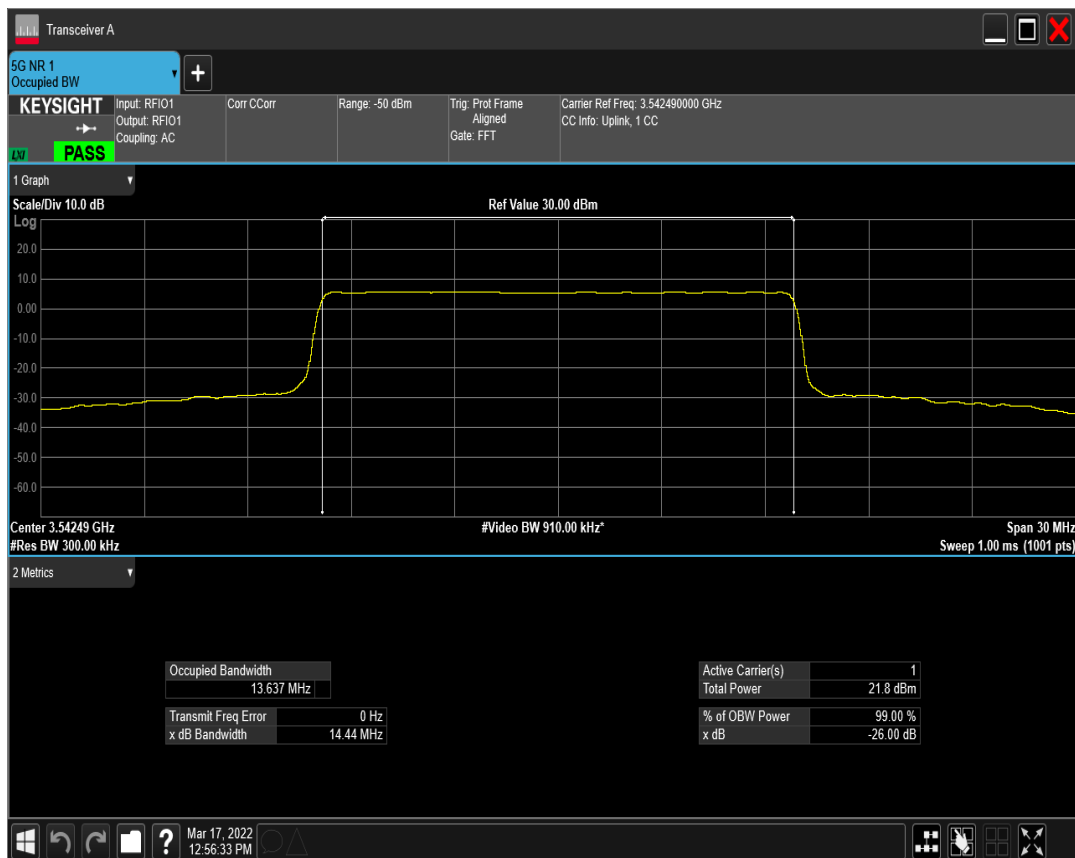
n77(3450-3550) SCS=30kHz DFT_BPSK BW=20MHz Channel=630668 RB=50@0
