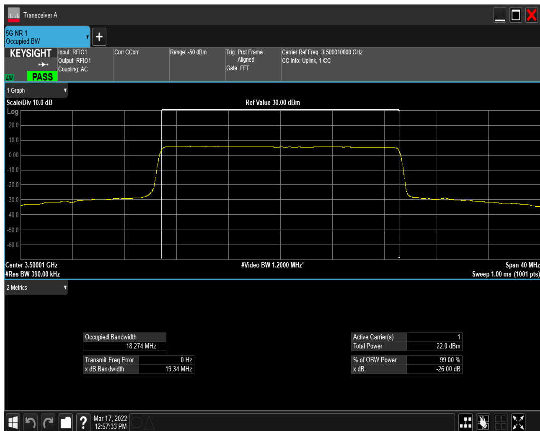
n77(3450-3550) SCS=30kHz DFT_BPSK BW=20MHz Channel=636000 RB=50@0
