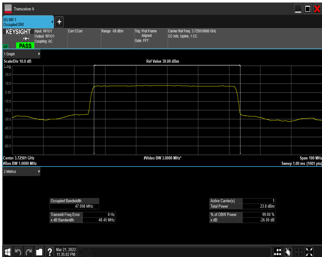
n77(3700-3980) SCS=30kHz DFT_QPSK BW=50MHz Channel=648334 RB=128@0
