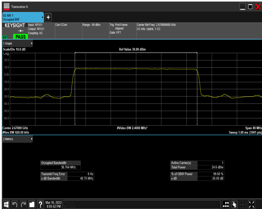
n41 SCS=15kHz DFT_QPSK BW=40MHz Channel=534000 RB=216@0
