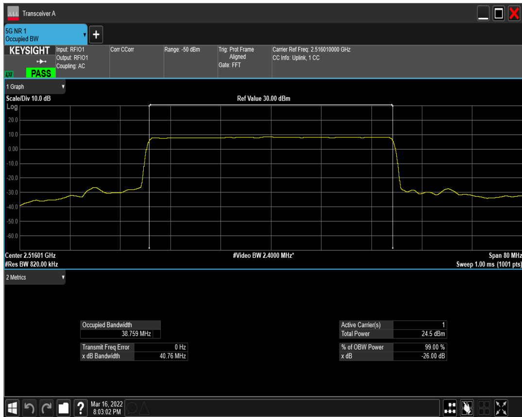
n41 SCS=15kHz DFT_QPSK BW=40MHz Channel=503202 RB=216@0
