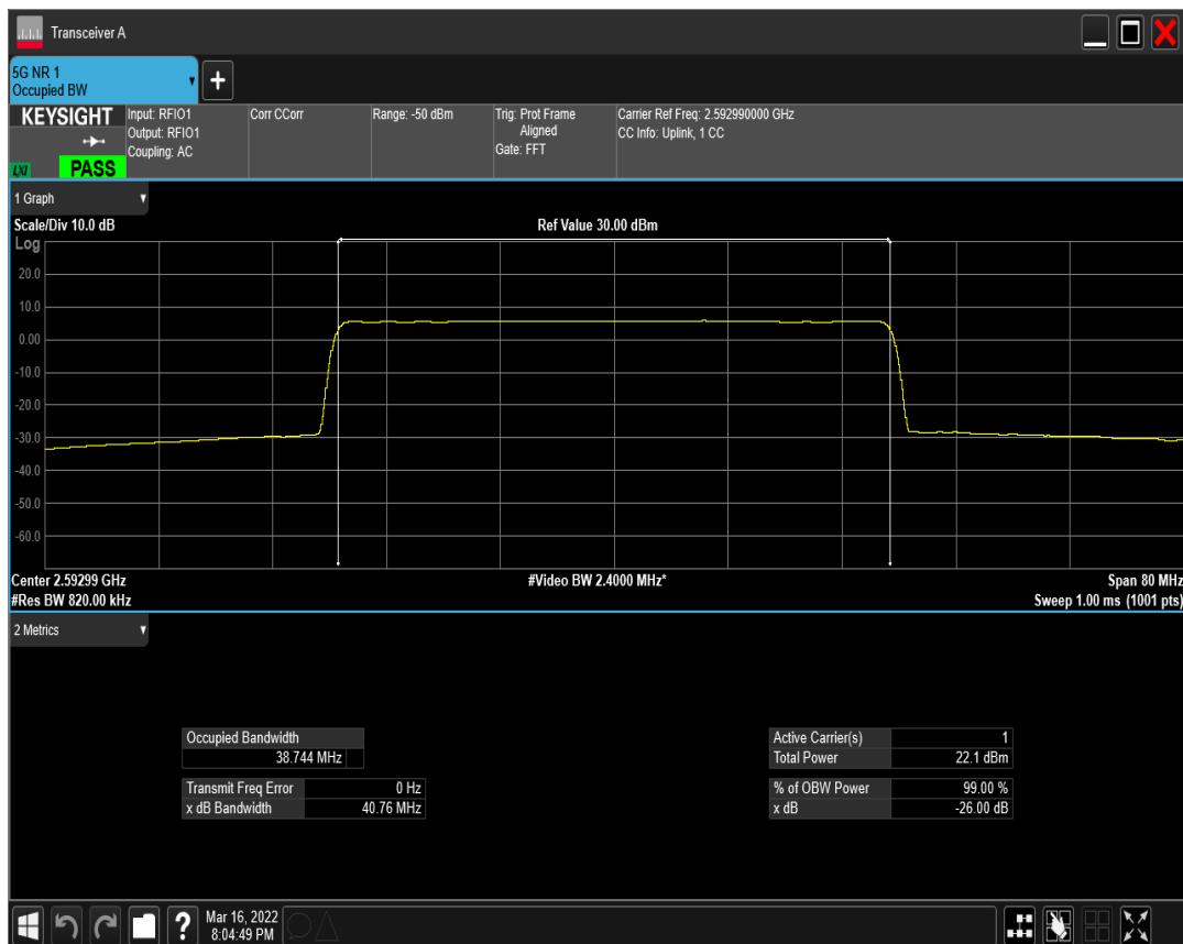
n41 SCS=15kHz DFT_BPSK BW=40MHz Channel=534000 RB=216@0
