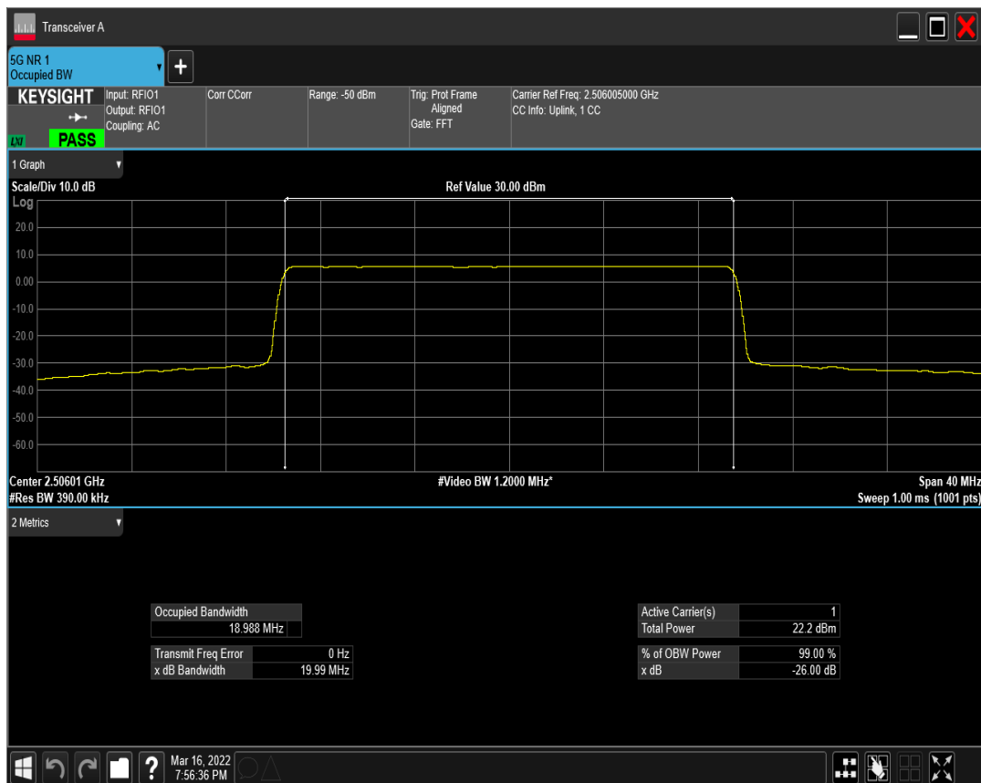
n41 SCS=15kHz DFT_BPSK BW=20MHz Channel=518601 RB=100@0
