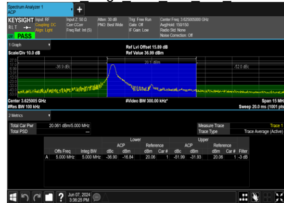
B2_N48(5M)_DFT-s-OFDM_PI_2- BPSK Edge 1RB Left Mid CH
