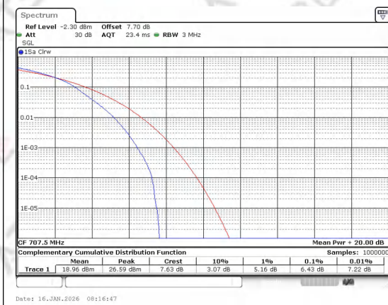
Band 12 1.4MHz/707.5/Mid 64QAM 6@0
