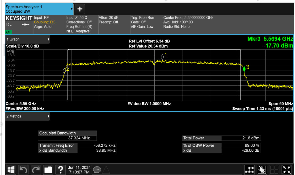
-26dB Bandwidth NVNT be40 5670MHz Ant1
