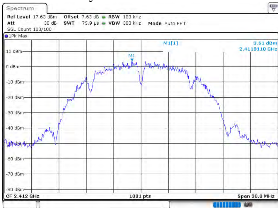
Band Edge NVNT 802.11b 2412MHz Ant1 Ref
