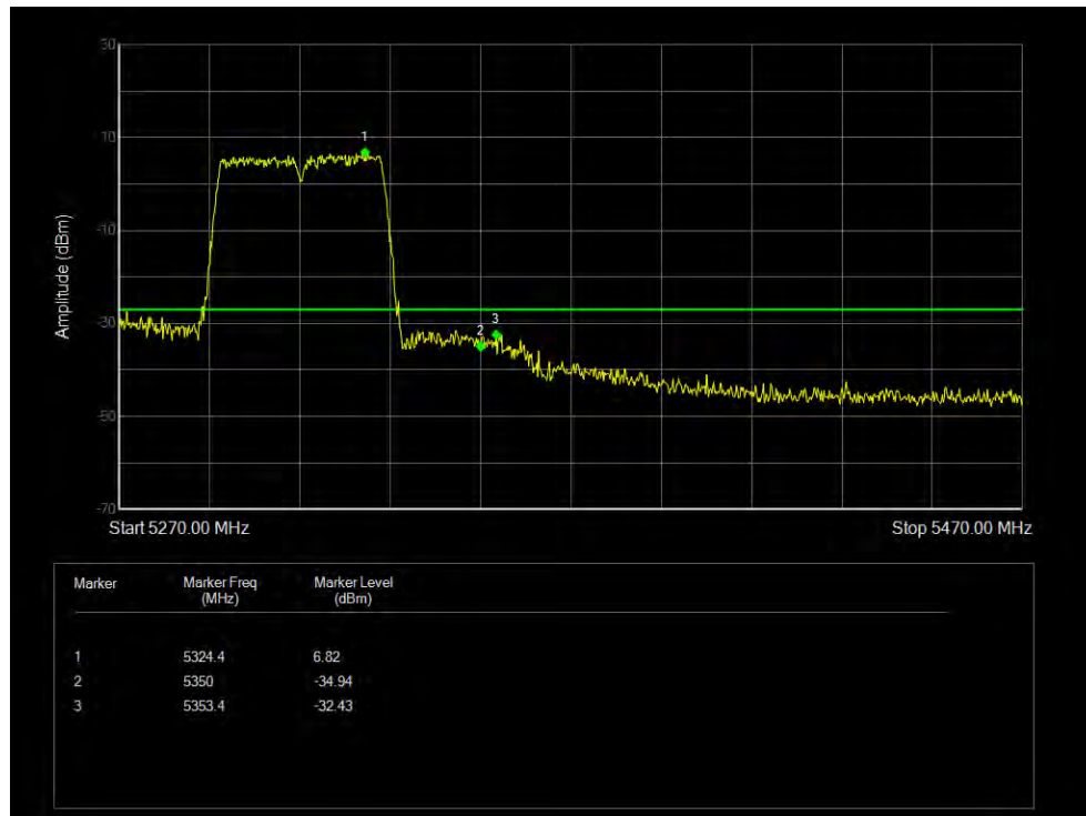
Band Edge NVNT 802.11ac40 5310MHz High Ant 1
