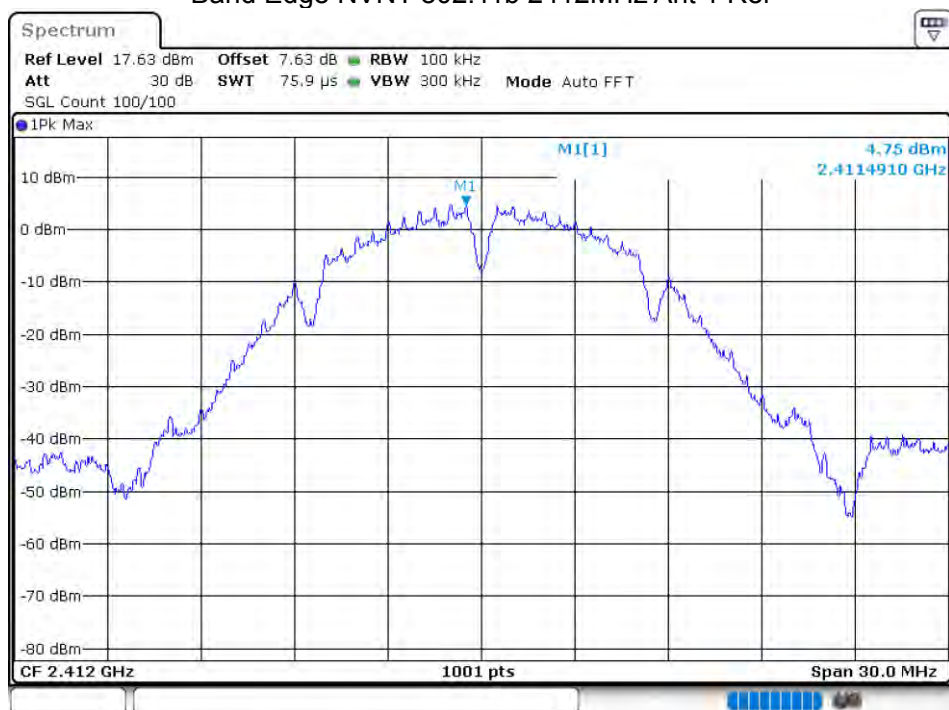
Band Edge NVNT 802.11b 2412MHz Ant 1 Ref
