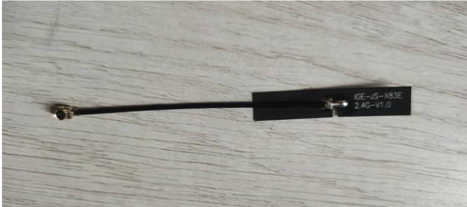
JS-X83E-2.4G 天线 FPC 黑色 To IPEX 一代 Cable OD1.13mm 黑色 L65mm
