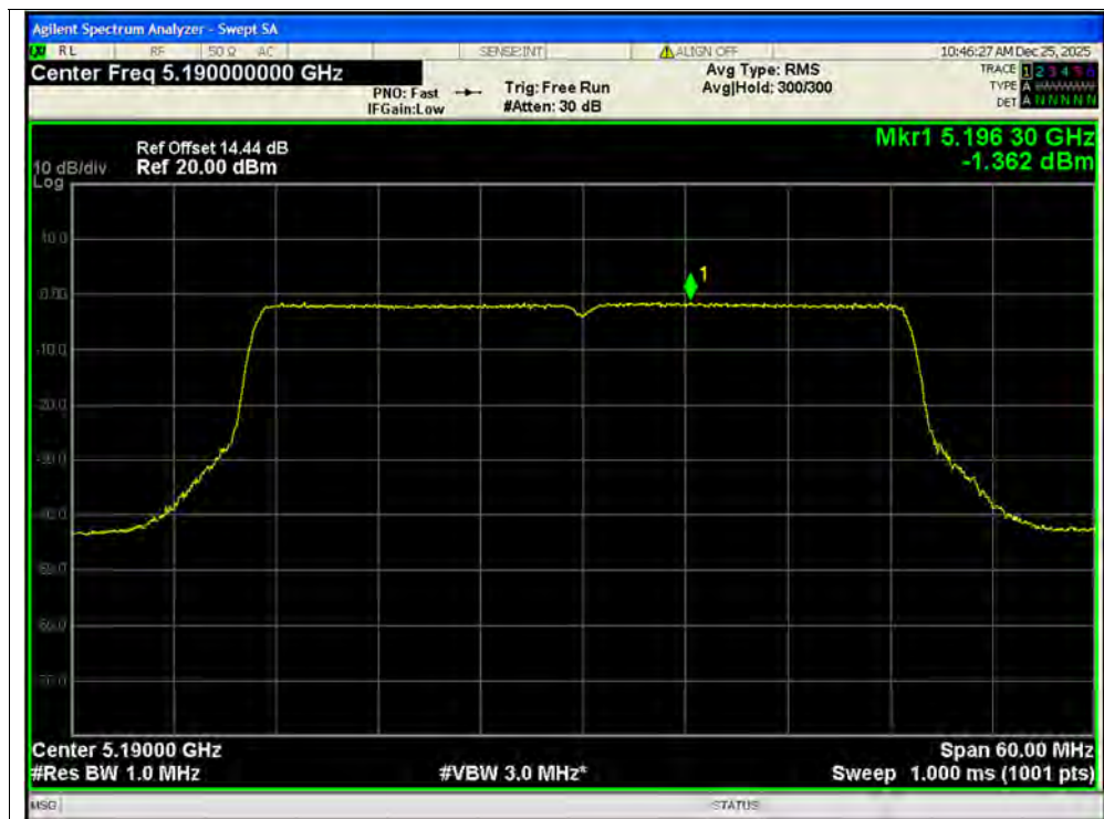
PSD NVNT be40 5190MHz Ant1 MIMO
