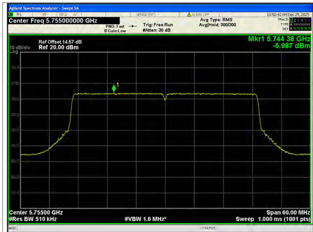
PSD NVNT be40 5755MHz Ant1 MIMO
