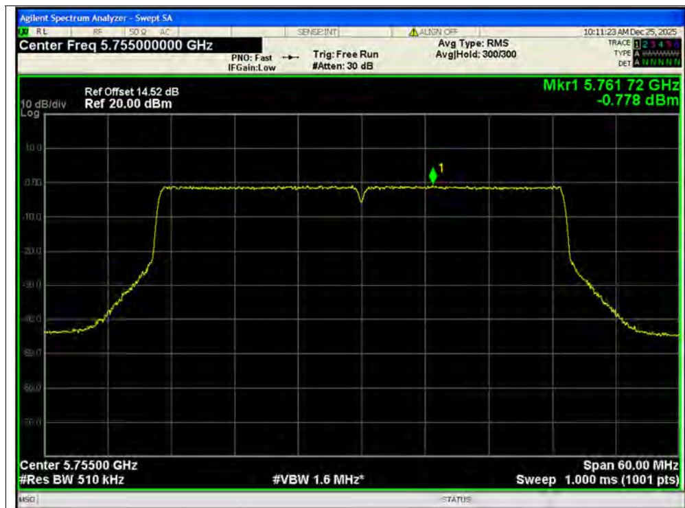
PSD NVNT be40 5755MHz Ant2 SISO
