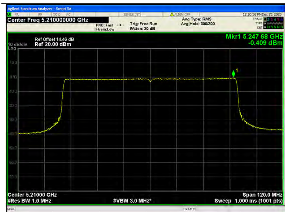
PSD NVNT ax80 5210MHz Ant1 SISO
