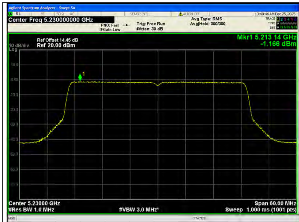
PSD NVNT be40 5230MHz Ant1 MIMO
