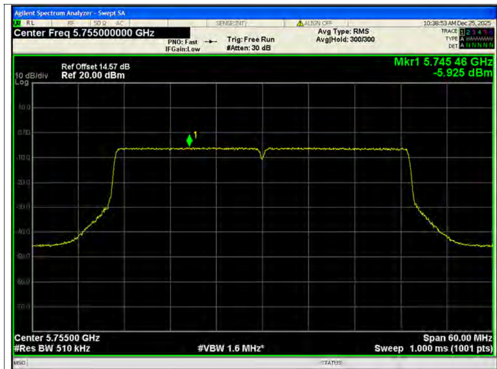
PSD NVNT ax40 5755MHz Ant1 MIMO
