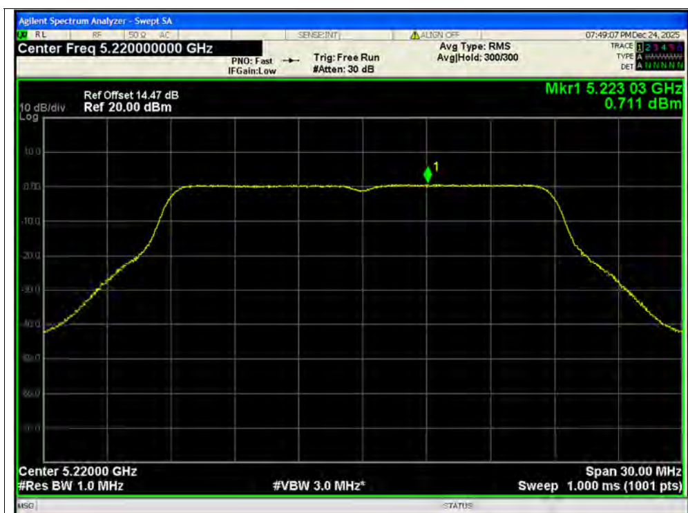
PSD NVNT ac20 5220MHz Ant1 MIMO
