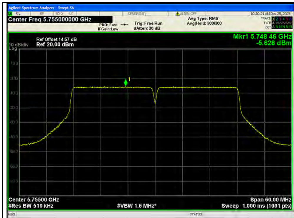
PSD NVNT ac40 5755MHz Ant1 MIMO
