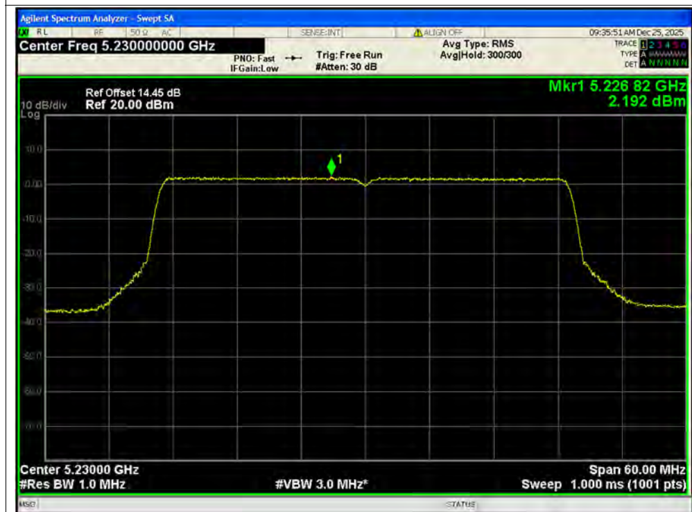
PSD NVNT ax40 5230MHz Ant1 SISO
