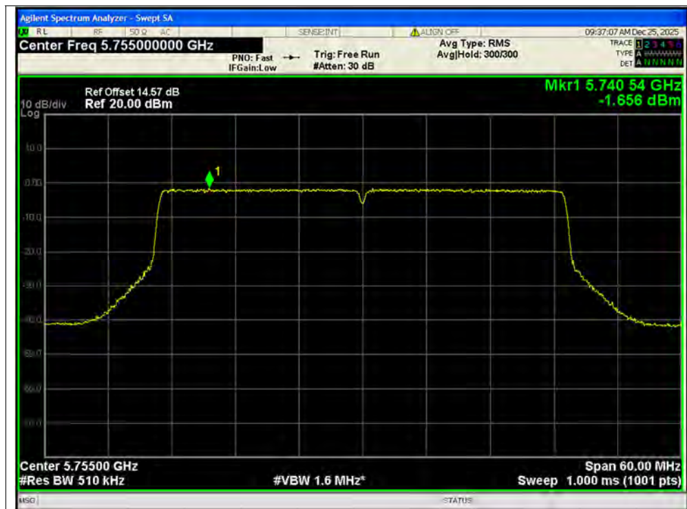
PSD NVNT ax40 5755MHz Ant1 SISO
