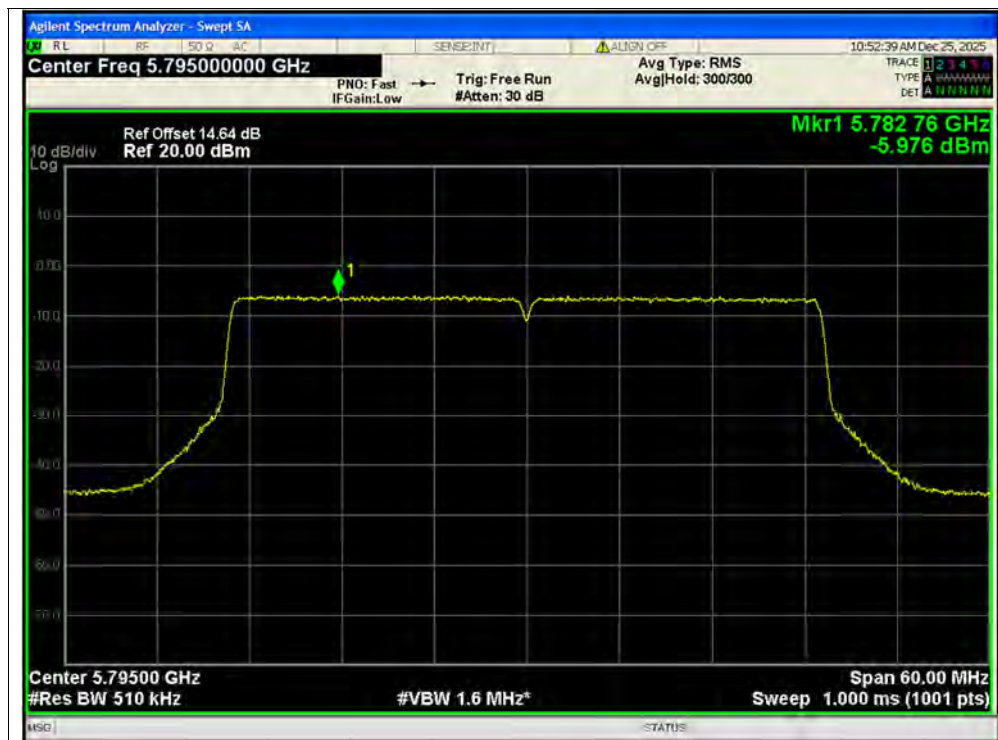
PSD NVNT be40 5795MHz Ant1 MIMO
