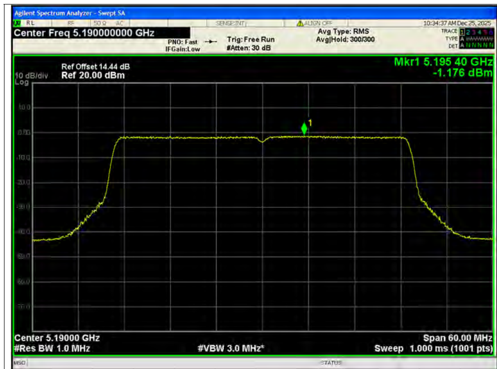
PSD NVNT ax40 5190MHz Ant1 MIMO
