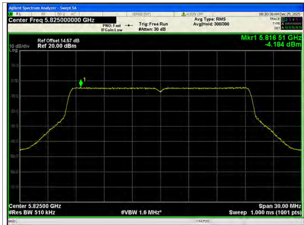
PSD NVNT ax20 5825MHz Ant1 MIMO
