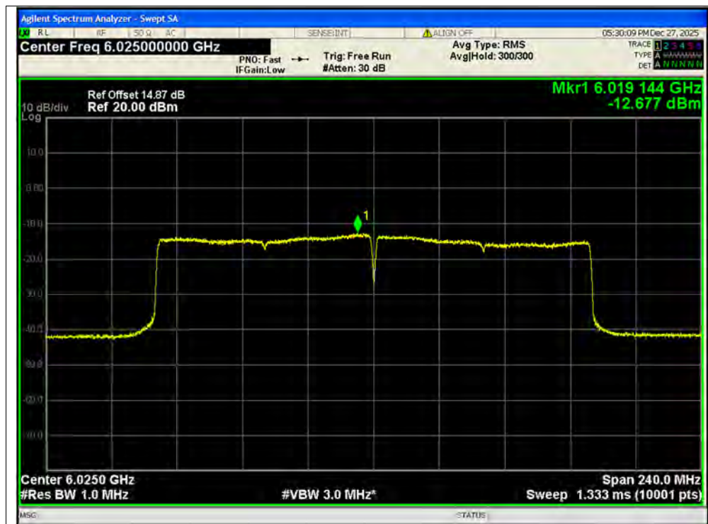
PSD NVNT ax160 6025MHz Ant1 MIMO
