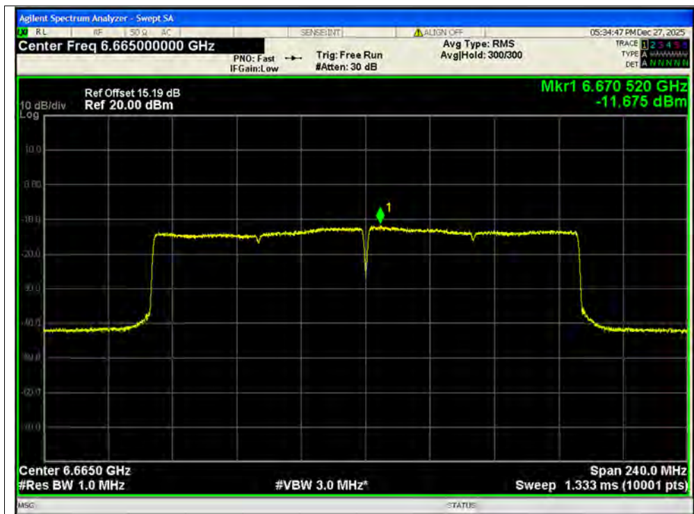
PSD NVNT ax160 6665MHz Ant1 MIMO
