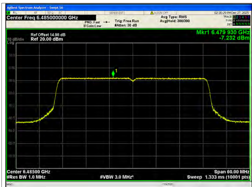
PSD NVNT ax40 6485MHz Ant1 SISO
