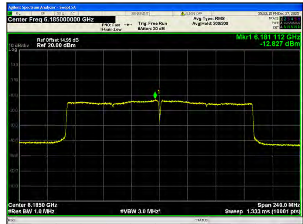
PSD NVNT ax160 6185MHz Ant1 MIMO
