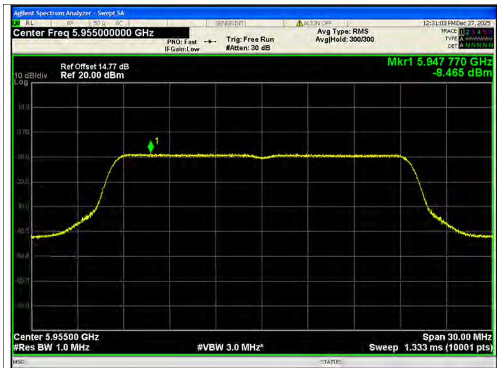
PSD NVNT ax20 5955MHz Ant1 SISO
