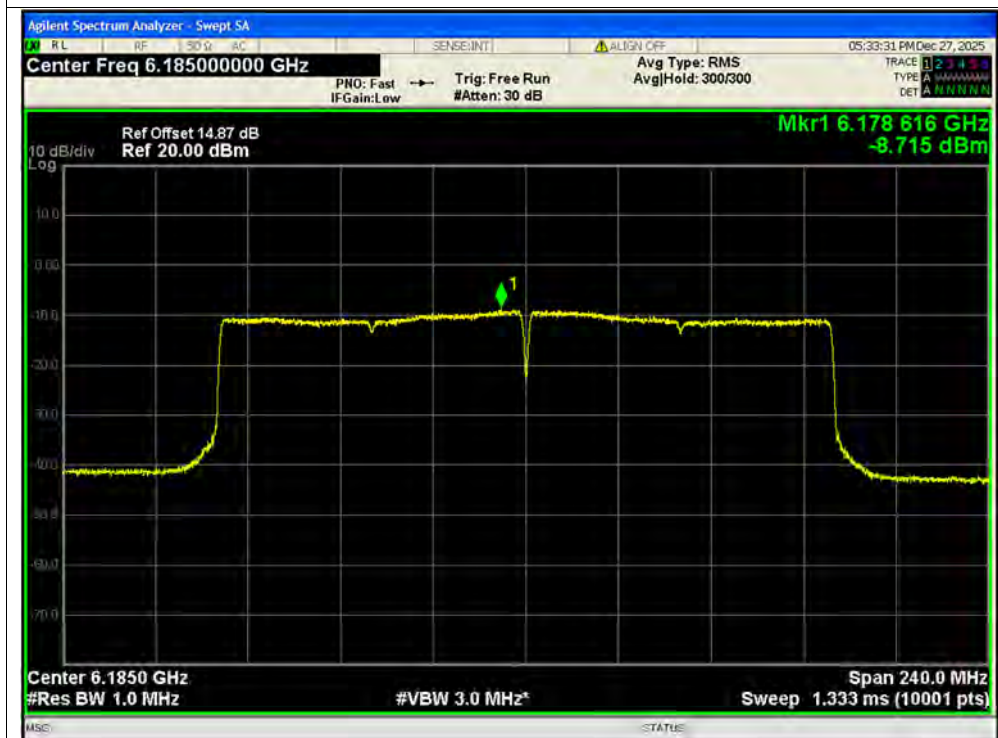
PSD NVNT ax160 6185MHz Ant2 MIMO
