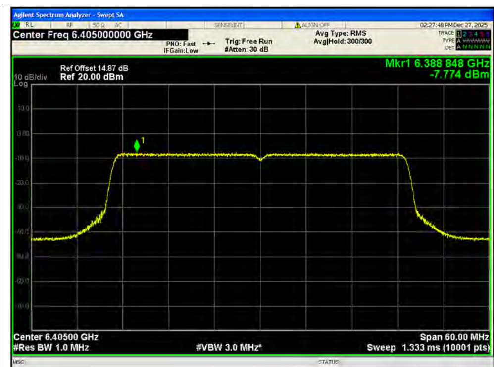
PSD NVNT ax40 6405MHz Ant1 SISO
