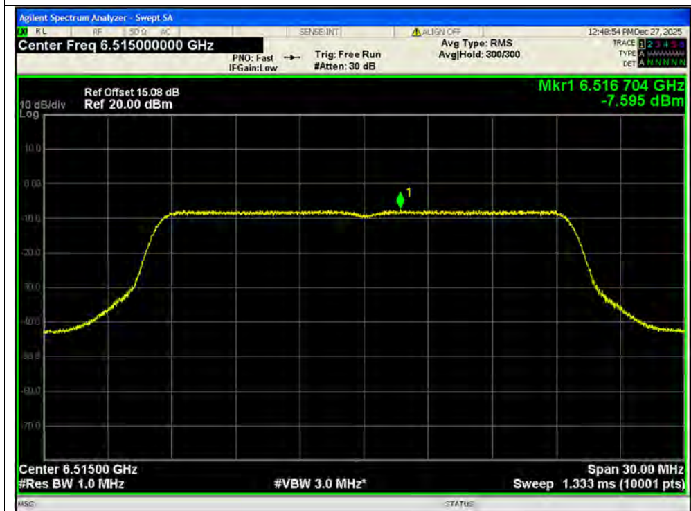
PSD NVNT be20 6515MHz Ant1 SISO
