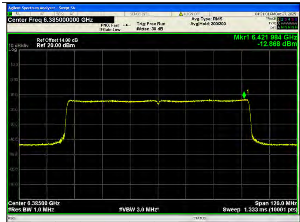
PSD NVNT ax80 6385MHz Ant1 MIMO
