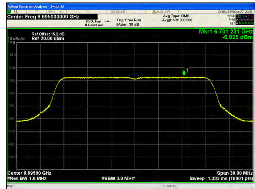
PSD NVNT be20 6695MHz Ant1 SISO
