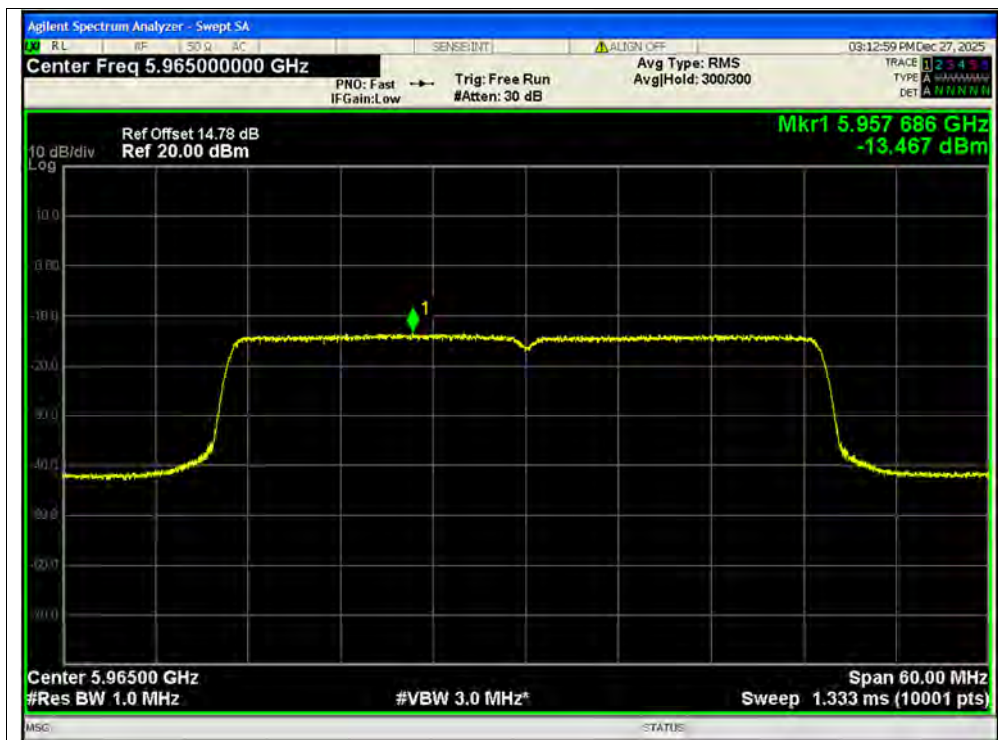
PSD NVNT ax40 5965MHz Ant1 MIMO
