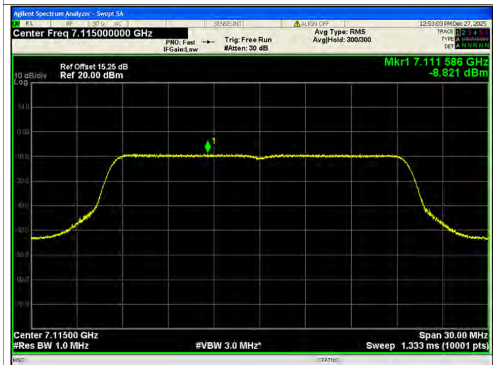
PSD NVNT be20 7115MHz Ant1 SISO
