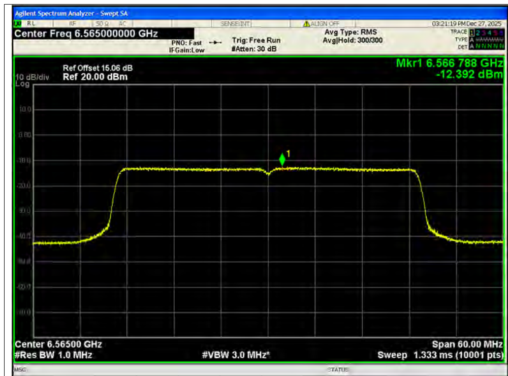
PSD NVNT ax40 6565MHz Ant1 MIMO
