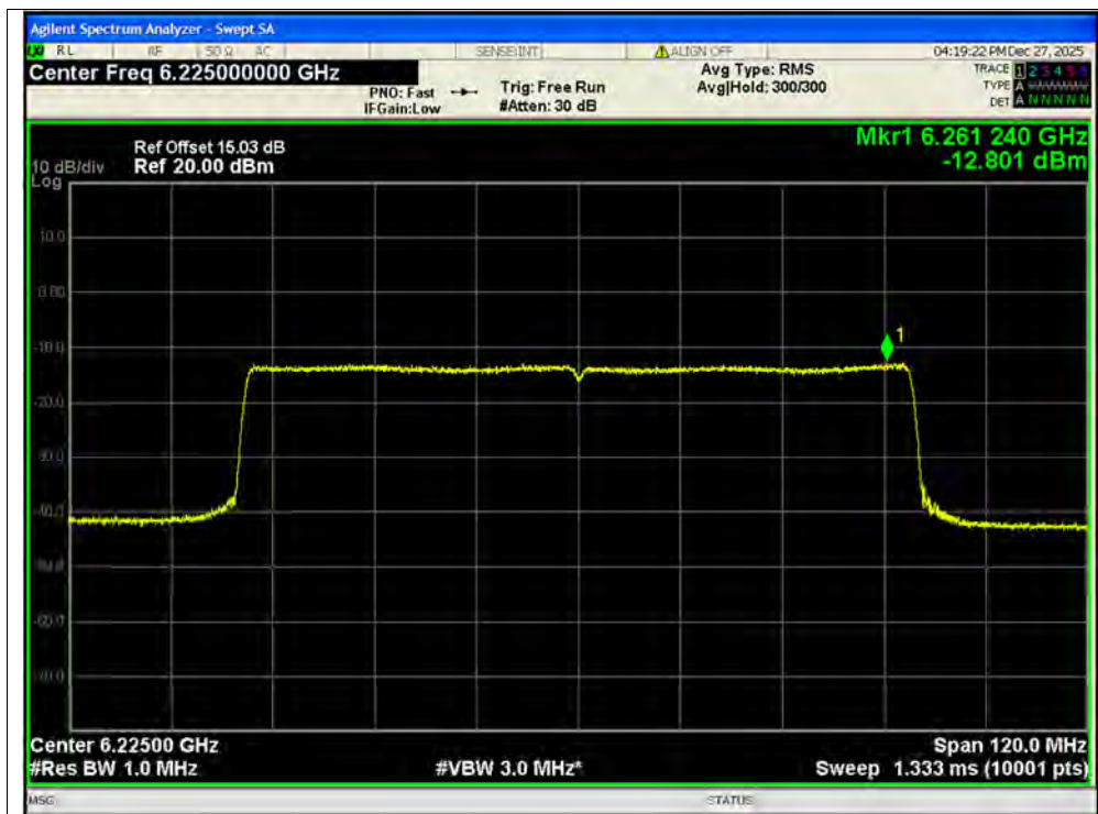
PSD NVNT ax80 6225MHz Ant1 MIMO
