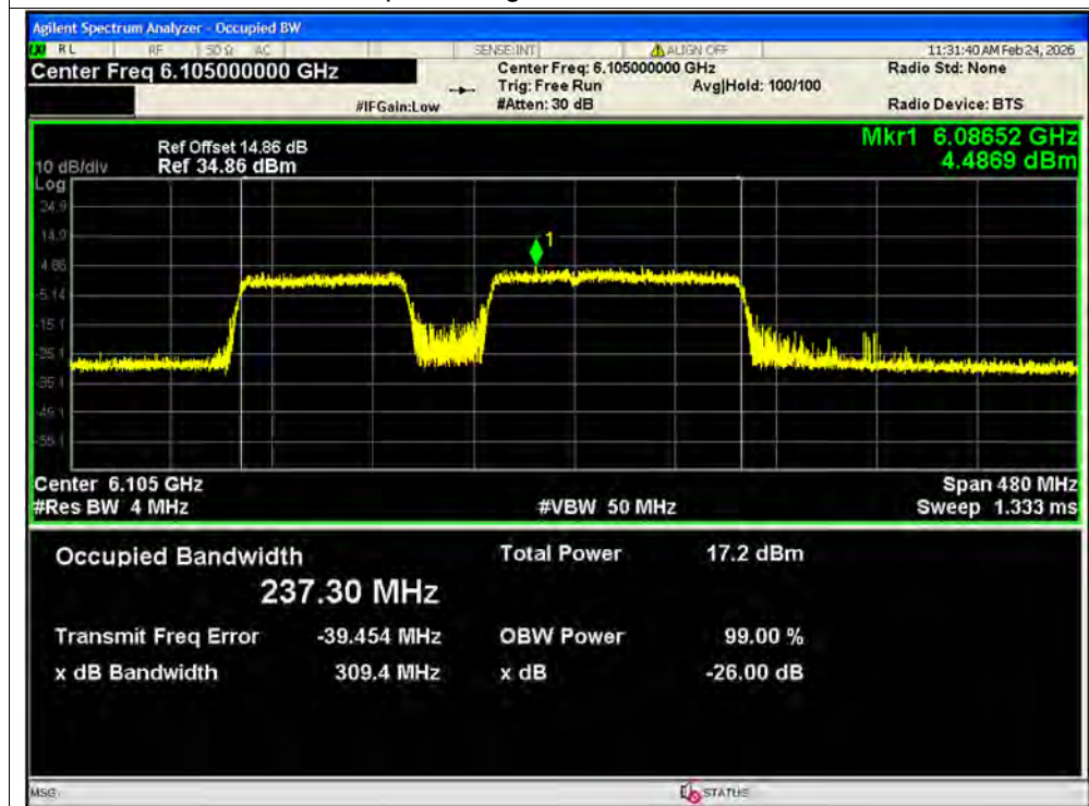
OBW NVNT be320 puncturing 80+40 MRU3 6105MHz Ant2 MIMO
