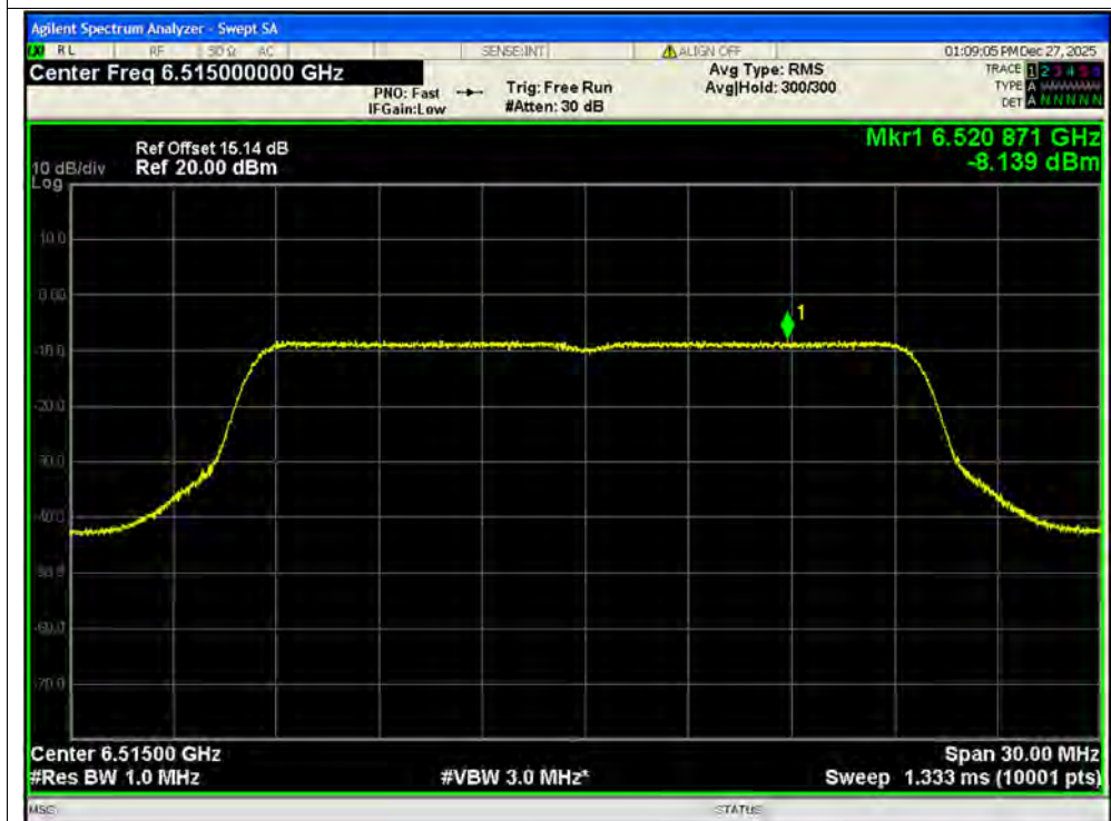
PSD NVNT ax20 6515MHz Ant2 SISO
