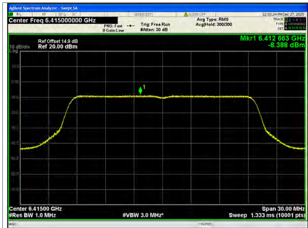
PSD NVNT ax20 6415MHz Ant1 SISO
