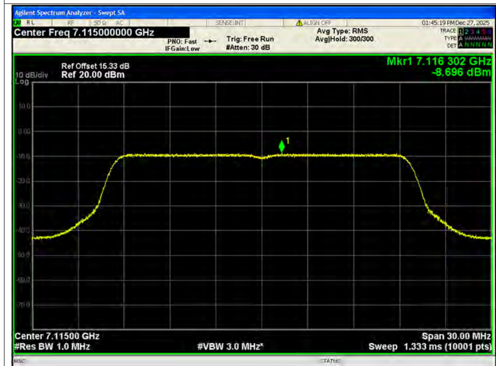
PSD NVNT ax20 7115MHz Ant2 MIMO
