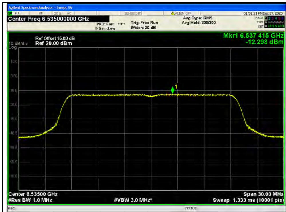
PSD NVNT ax20 6535MHz Ant1 MIMO
