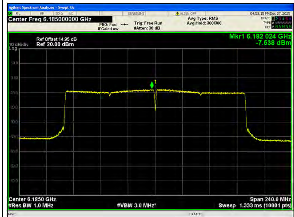
PSD NVNT ax160 6185MHz Ant1 SISO
