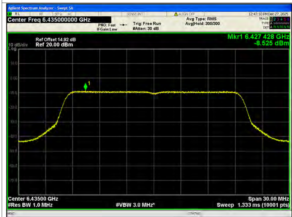
PSD NVNT be20 6435MHz Ant1 SISO
