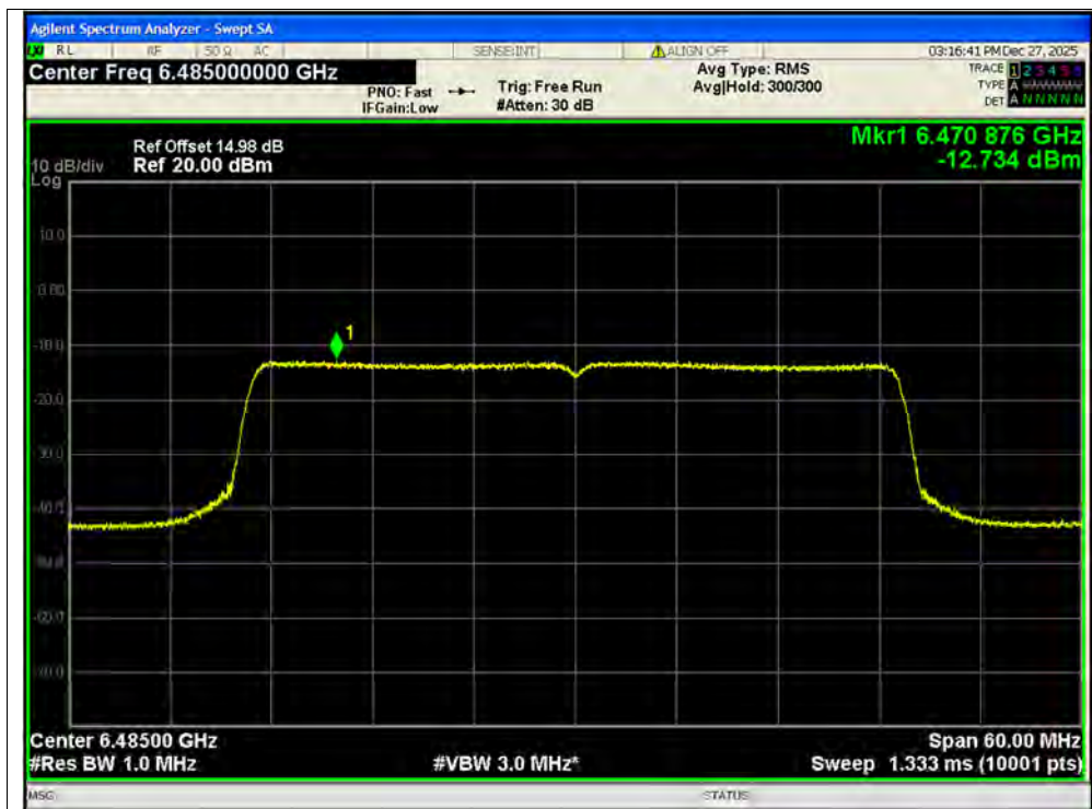
PSD NVNT ax40 6485MHz Ant1 MIMO
