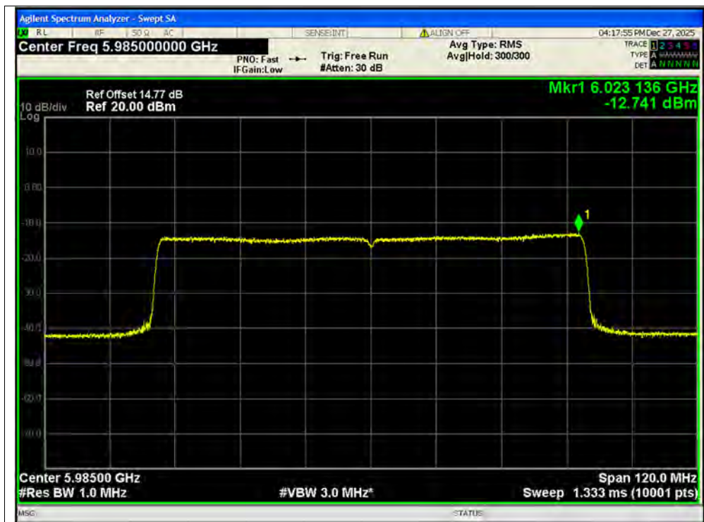
PSD NVNT ax80 5985MHz Ant1 MIMO
