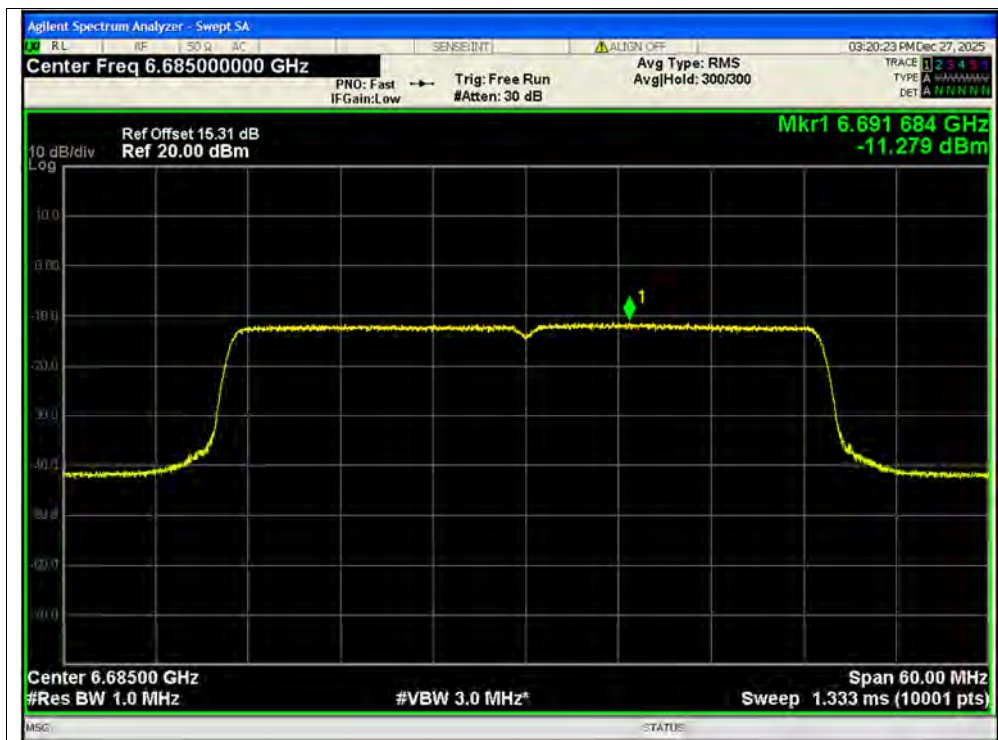
PSD NVNT ax40 6685MHz Ant1 MIMO
