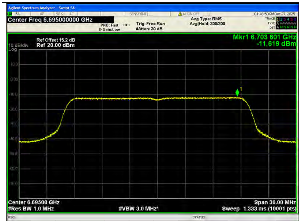
PSD NVNT ax20 6695MHz Ant1 MIMO
