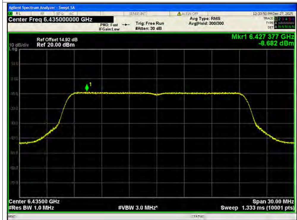
PSD NVNT ax20 6435MHz Ant1 SISO
