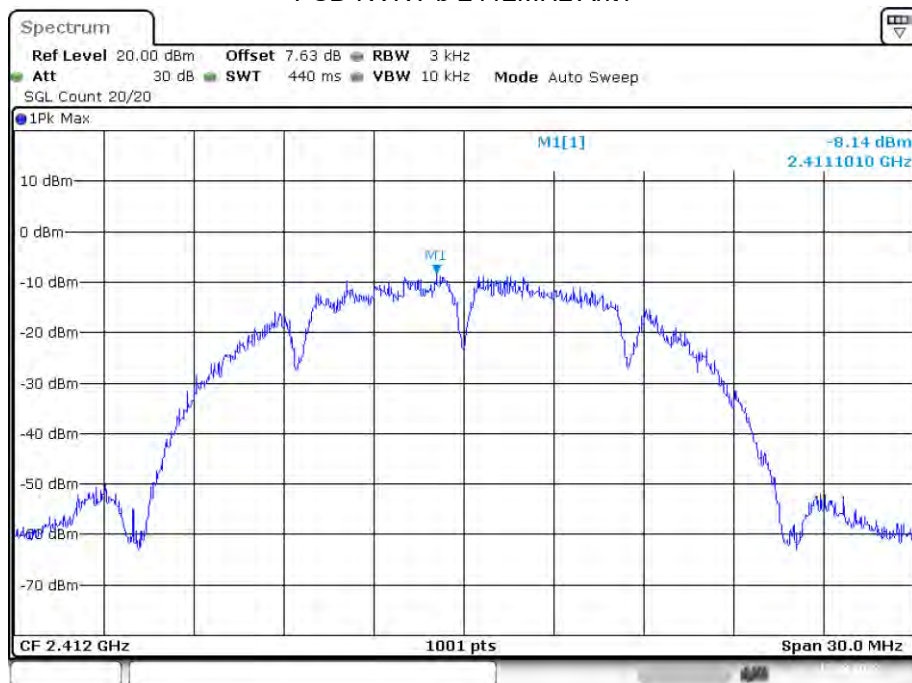
PSD NVNT b 2412MHz Ant1
