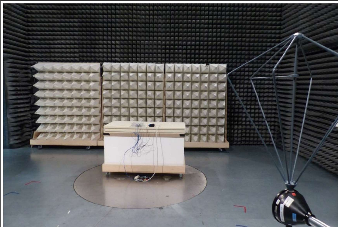
EUT Test setup 30-200MHz
