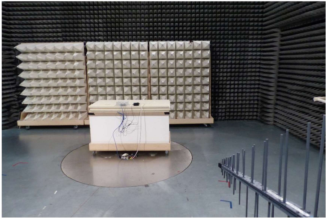
EUT Test setup 1-13GHz
