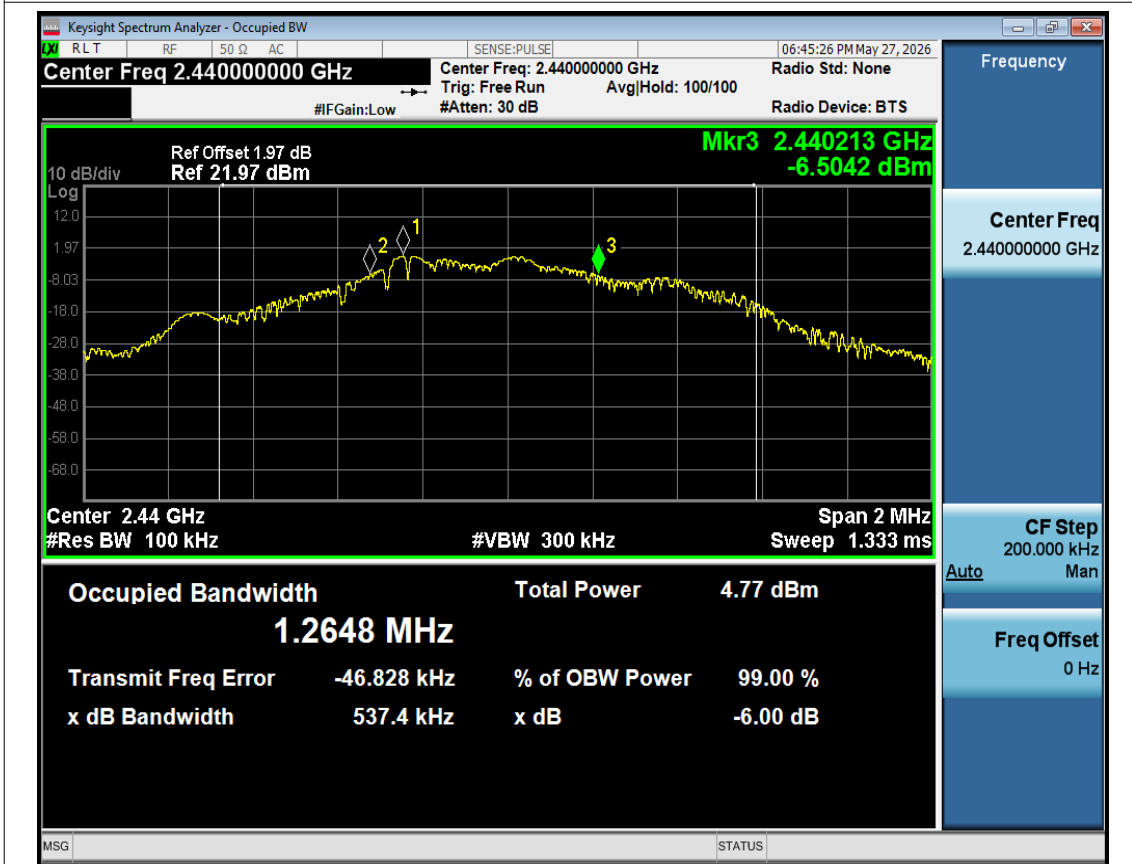
-6dB Bandwidth NVNT BLE 1M 2440MHz Ant1
