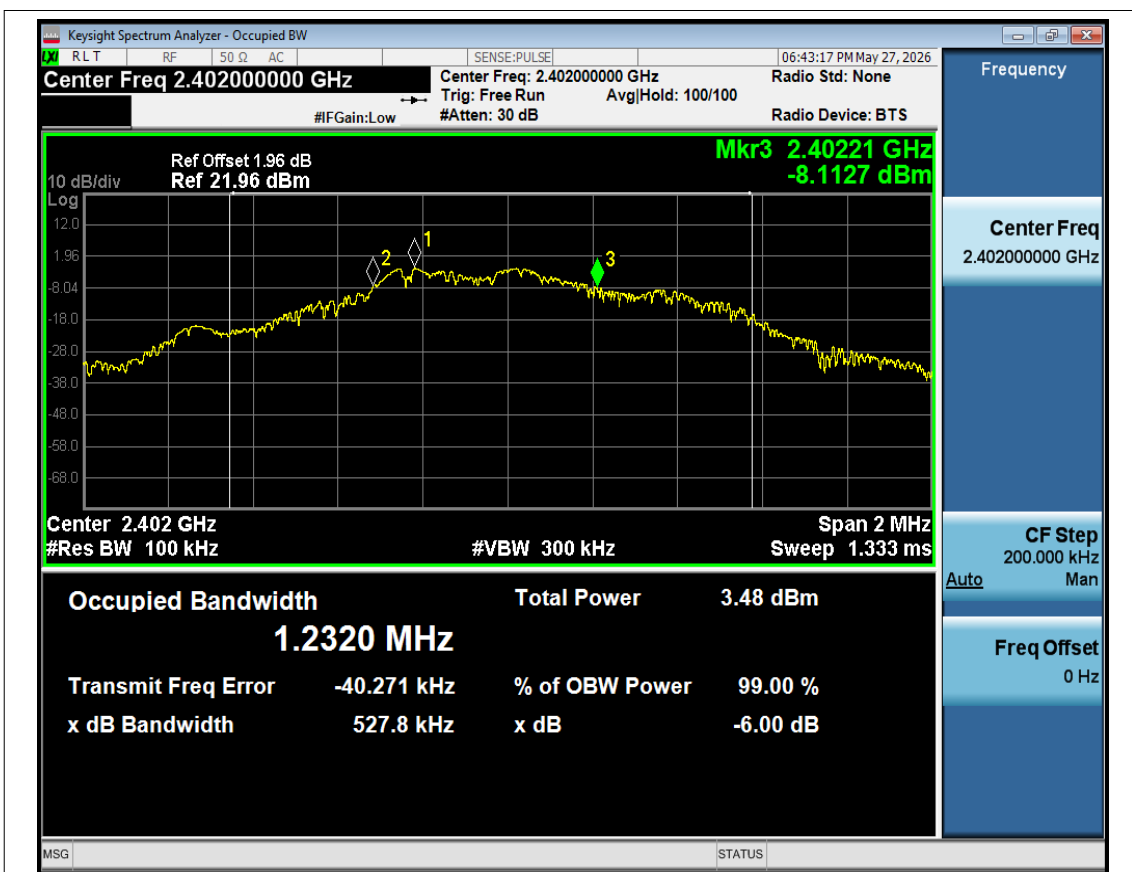
-6dB Bandwidth NVNT BLE 1M 2402MHz Ant1
