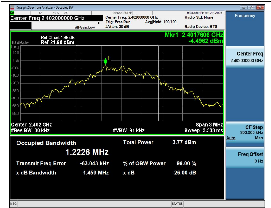
OBW NVNT GFSK 2402MHz Ant1
