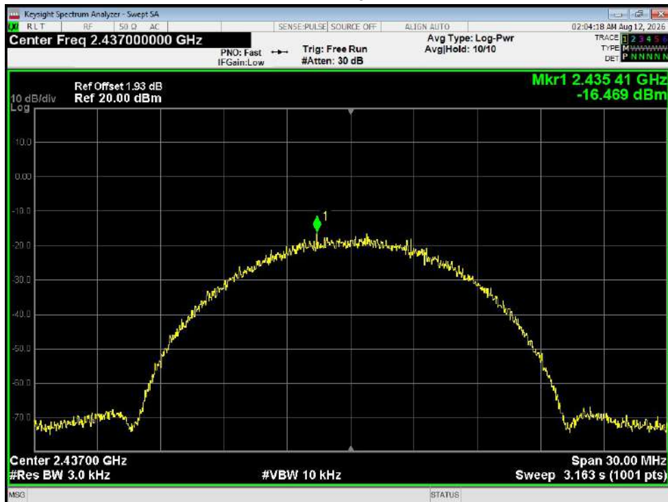
PSD NVNT b 2437MHz Ant1
