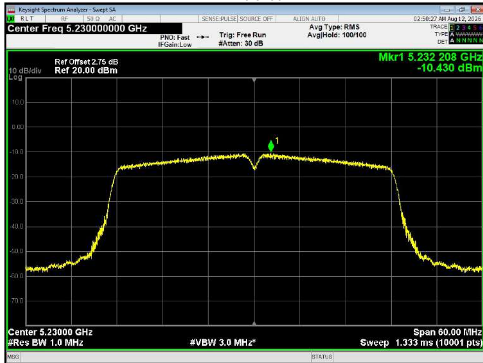
PSD NVNT ac80 5210MHz Ant1
