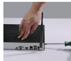
6. Vuelva a colocar la tapa y asegure los tornillos de la tapa.
