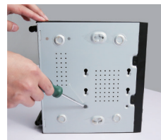
5. Asegure los tornillos del disco duro
