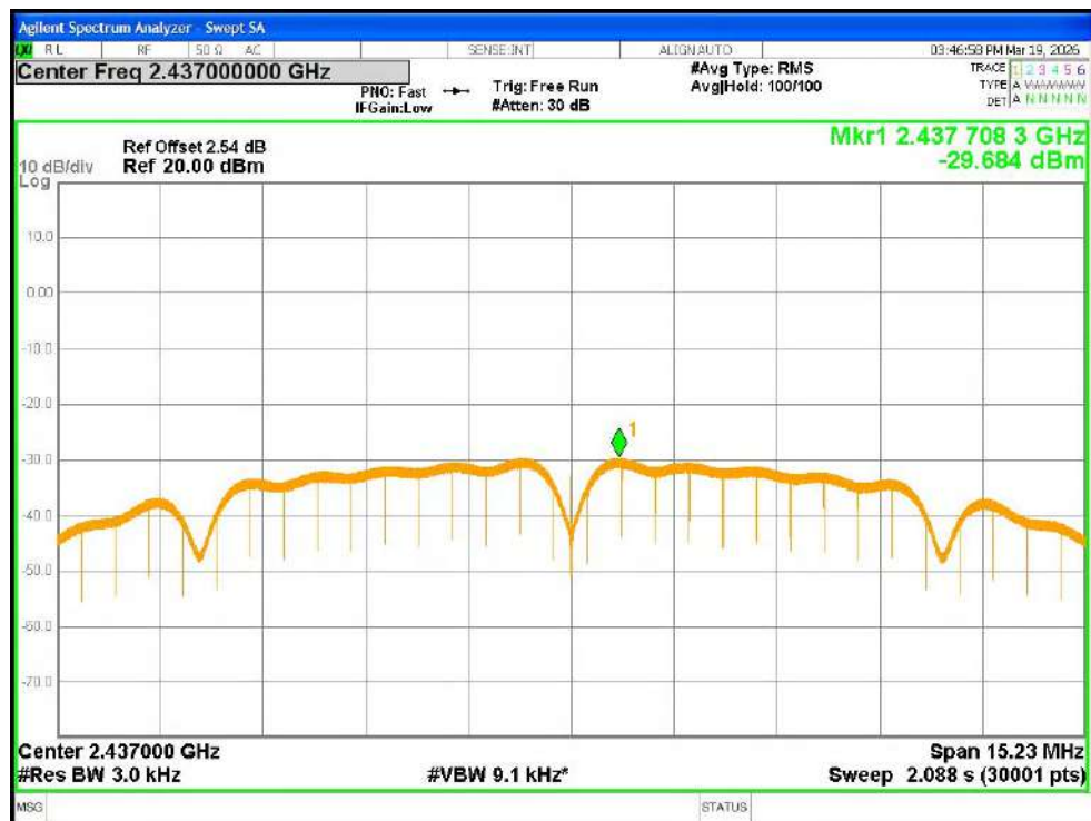
PSD NVNT b 2437MHz Ant1
