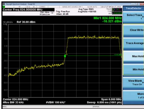
LTE Band 26 QPSK 5MHz CH-Low 1RB
