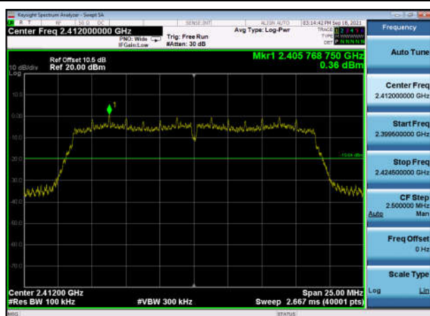
,Plot 1,Reference Level-802.11n(HT20) ,2462MHz,Ant0
