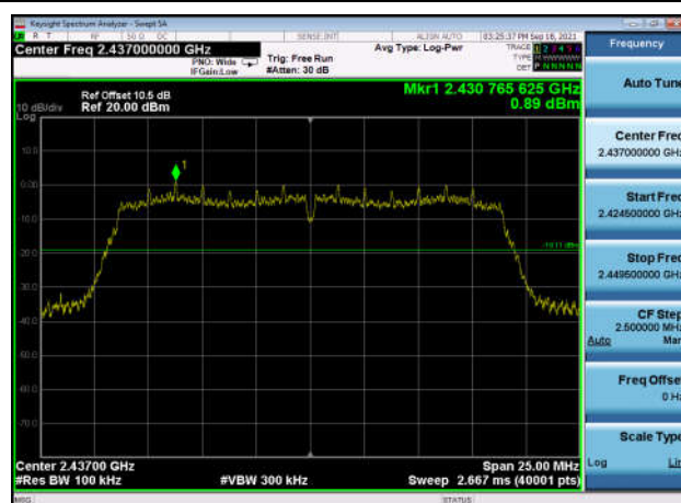
,Plot 2,Band Edge-802.11n(HT20) ,2412MHz,Ant0
