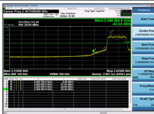
,Plot 2,Band Edge-802.11n(HT20) ,2462MHz,Ant0
