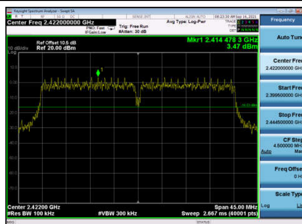
,Plot 1,Reference Level-802.11n(HT40) ,2452MHz,Ant0
