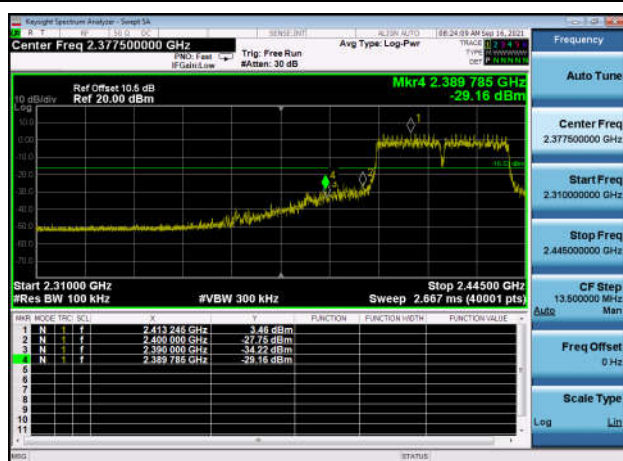
,Plot 2,Band Edge-802.11n(HT40) ,2452MHz,Ant0
